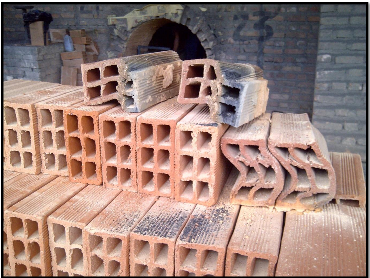
Figura 22. Deformación de bloques en la parte baja de la recámara.
