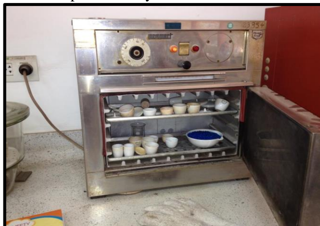
Figura 6: los crisoles en el horno para el ensayo de humedad.
