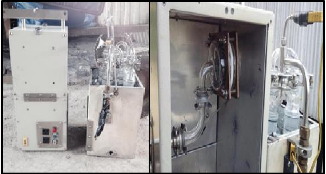
Figura 14. Tubos impiyect en la caja fría unida al porta filtro de la caja caliente.
