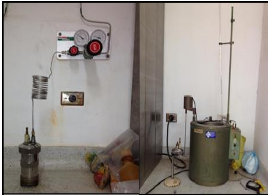
Figura 8. Bomba calorimétrica Izquierda. Cilindro presurizado a 30 atm.
