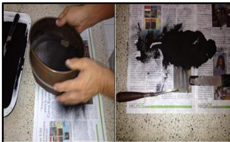
Figura 4: muestra lista para usarse. Izquierda tamiz (malla 100 hilos por \text{cm}^2 )
