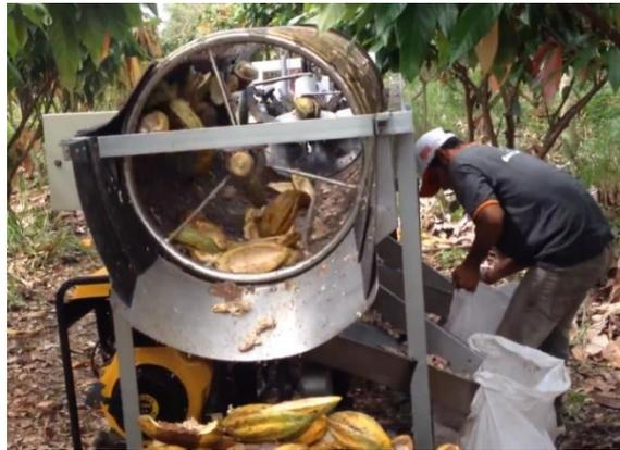
*Figura 30.* Despulpador cilíndrico con orificio. (Martínez Gómez 2018). Obtenido de <https://www.youtube.com/watch?v=DbZhiFLCy8>
