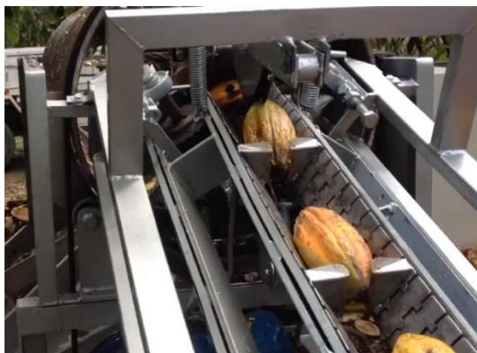
*Figura 27.* Alimentación por banda transportadora metálica en V. (Martínez Gómez 2018).
