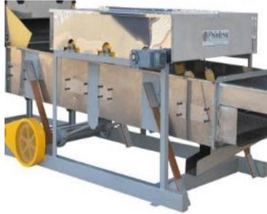
*Figura 31.* Despulpador vibratorio. (Pinhalense 2009). Obtenido de <http://www.timsacr.com/online/modules/info/index.php?id=6>
