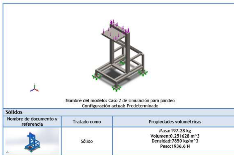
Figura 58. Información del modelo, Análisis de Pandeo
