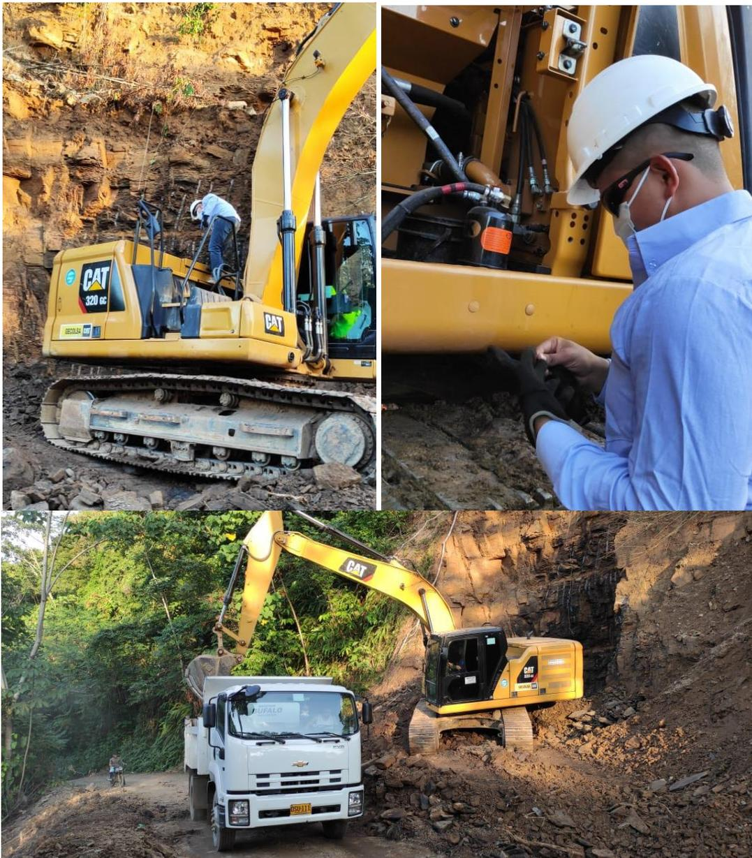
*Nota:* Supervisión del sistema hidráulico de la excavadora, Revisión de niveles de presión de llanta de las volquetas, alistamiento y adecuación de condiciones operativa de los equipos excavadora y volquetas.
