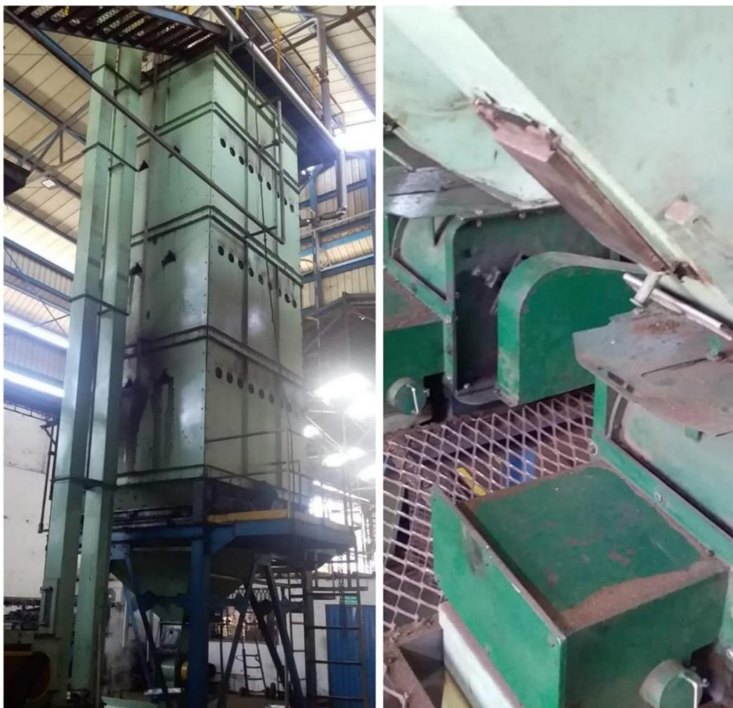
*Figura 11.* Silos de secado de almendra- Molinos tipo ripple mil.
