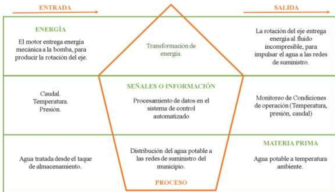
*Figura 13.* Diagrama de fronteras de las bombas centrífugas.
