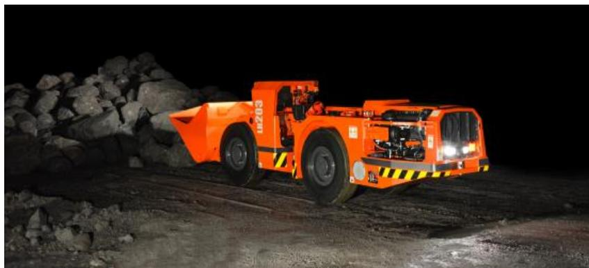
Figura 4. Cargador SANDVIK LH203. Fuente. SANDVIK
