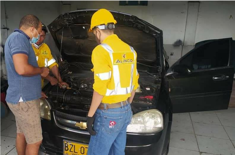
Figura 37. Revisión de inyectores Chevrolet Optra. Fuente. Álvaro Rincón.
