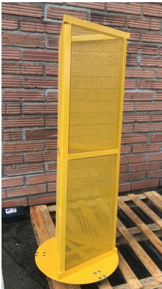
**3.3.2.4 Soporte de diplomas y espejos deformes para consultorio médico.** En la figura 54 se evidencia la fabricación del soporte para los espejos deformes.
