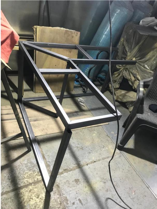
**3.3.2.3 Medio almacenamiento de piezas de geometría para fachada delantera y trasera de vehículos.** En la figura 53 se muestra el avance del proceso de fabricación del medio a fabricar.
