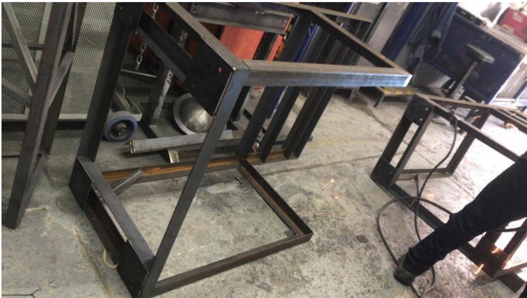
**3.3.2.2 Estructura metalmecánica para jacuzzi.** En la figura 52 se evidencia la fabricación de las estructuras metal metálicas para el jacuzzi.
