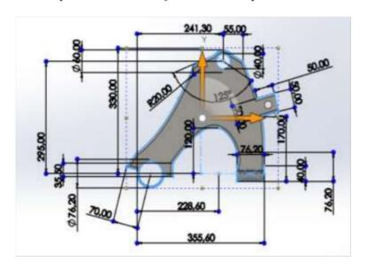
Nota. Medidas del diseño de la pieza muestra realizada en SolidWorks (Serrano Rincon, Navarro Torrado, & Florez Solano, 2020)
