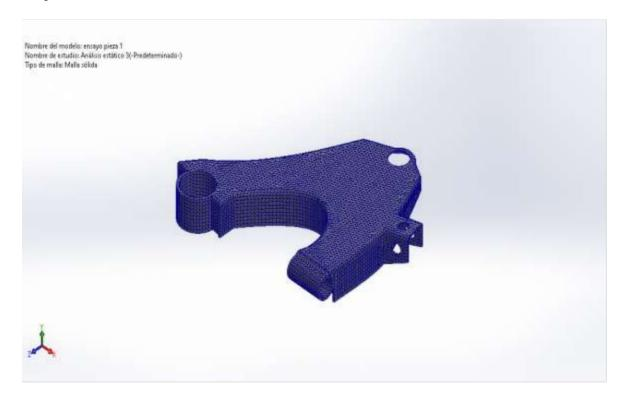
Nota. Diseño de la malla para simulación de esfuerzos en la pieza modelo (Serrano Rincon, Navarro Torrado, & Florez Solano, 2020)
