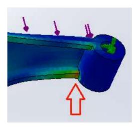
Nota. Imagen que indica deformaciones notorias (de color rojo) en la parte inferior de la union entre el brazo y el chasis del vehiculo (Serrano Rincon, Navarro Torrado, & Florez Solano, 2020)
