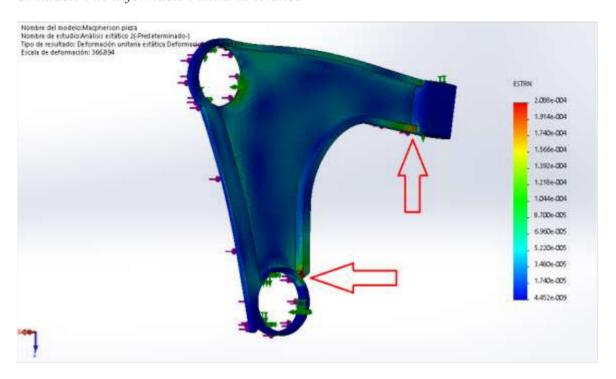
Nota. Imagen de resultados de una simulación de esfuerzo estatico lineal en un brazo inferior de una suspension McPherson (Serrano Rincon, Navarro Torrado, & Florez Solano, 2020)
