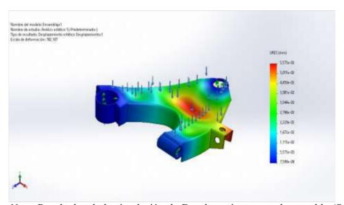
Nota. Resultados de la simulación de Desplazamientos en el ensamble (Serrano Rincon, Navarro Torrado, & Florez Solano, 2020)
