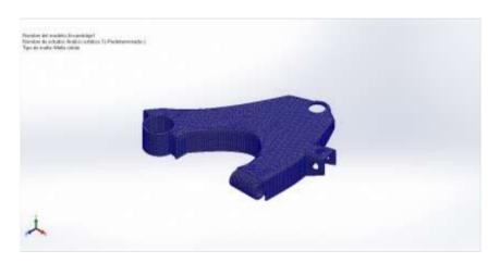
Nota. Diseño de malla del ensamble de la pieza muestra y el refuerzo de material (Serrano Rincon, Navarro Torrado, & Florez Solano, 2020)
