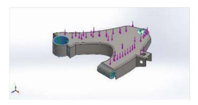
Nota. Simulación de esfuerzos en la pieza modelo diseñada en SolidWorks (Serrano Rincon, Navarro Torrado, & Florez Solano, 2020)
