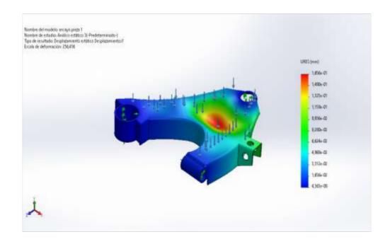
Nota. Resultados de la simulación de desplazamientos en la pieza (Serrano Rincon, Navarro Torrado, & Florez Solano, 2020)
