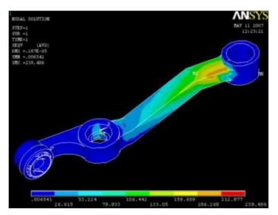
Nota. Imagen de efectos de los esfuerzos estructurales a los que son sometidos piezas como el brazo oscilante de una suspensión de puntal McPherson delantera (Li-Zhen & Zhi-feng, 2014)
