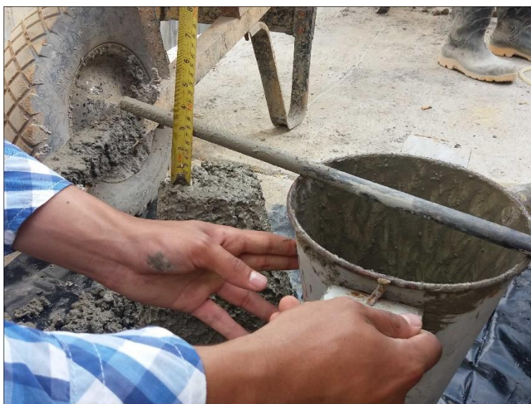
Figura 56. Determinación mediante el Cono de Abrams el asentamiento del concreto en campo. Autores del proyecto.
