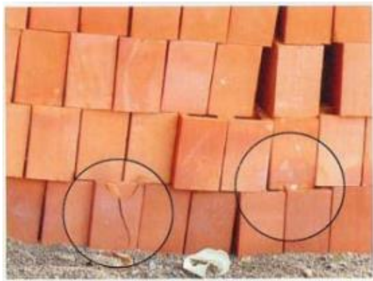
Figura 12. Muestra de cómo el desnivel ocasiona desbordados y roturas. (Ladrillera Melendez, 2018)
