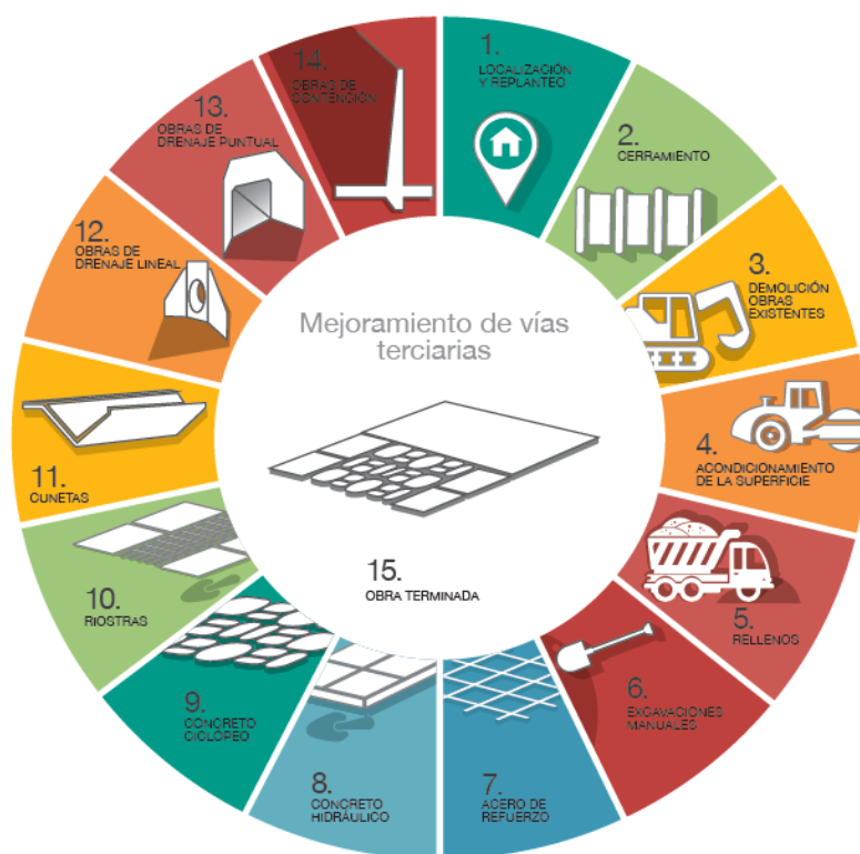
Figura 8 . Procesos constructivos de una vía terciaria.
