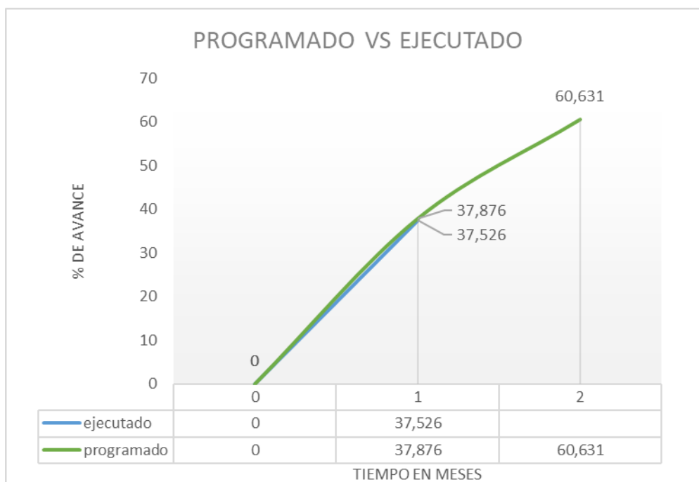
Figura 30. Avance físico de obra en el primer informe de interventoría contrato de reposición de redes de alcantarillado.
