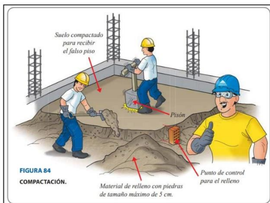
Figura 1. Compactación. Construye seguro. Manual del maestro constructor (2010). Obtenido https://www.acerosarequipa.com/manuales/pdf/manual-del-maestro-constructor.pdf
