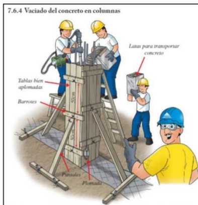
Figura 10. Vaciado del concreto en columnas. Construye seguro. Manual del maestro constructor (2010). Obtenido https://www.acerosarequipa.com/manuales/pdf/manual-del-maestro-constructor.pdf
