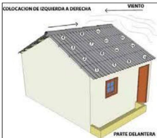
Figura 21. Colocación de izquierda a derecha de tejas de zinc. obtenido https://encrypted-tbn0.gstatic.com/images?q=tbn:ANd9GcRqYiZ9u_1n4enCbBeXyL_Sy_ydJrrEbE1Rdg&usqp=CAU
