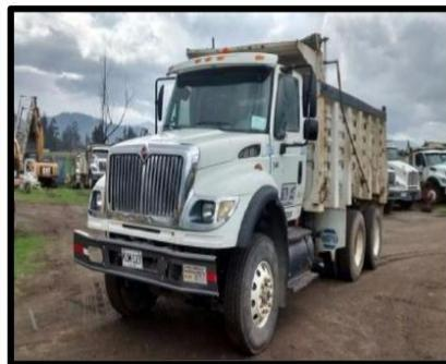
*Figura 13. Doble troque, vehículo aprobado en Colombia para el transporte de material*
