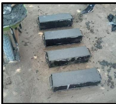
*Figura 41. Cuatro especímenes para luego realizar pruebas de compresión y flexión*
