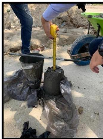
*Figura 40. Asentamiento a muestra de concreto del mixer*
