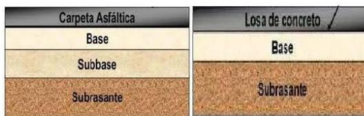
Figura 6. Estructura Pav. flexible
