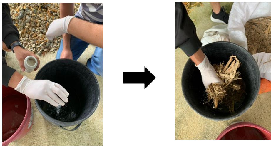
Figura 5. Tratamiento de la fibra natural con Hidróxido de Sodio
