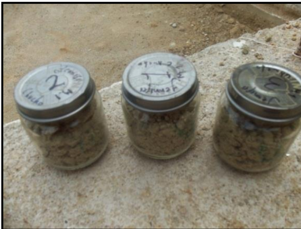
Fotografía 21. Muestras contenido de humedad.
