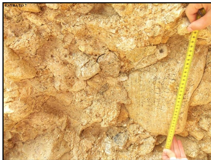
Fotografía 57. Estrato 7 de suelo que conforma el talud (conglomerado).
