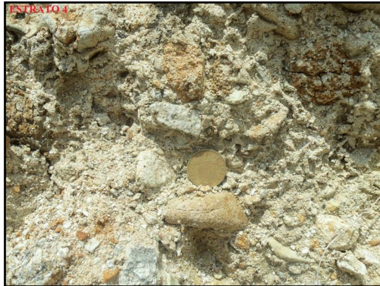
Fotografía 54. Estrato 4 de suelo que conforma el talud (conglomerado).
