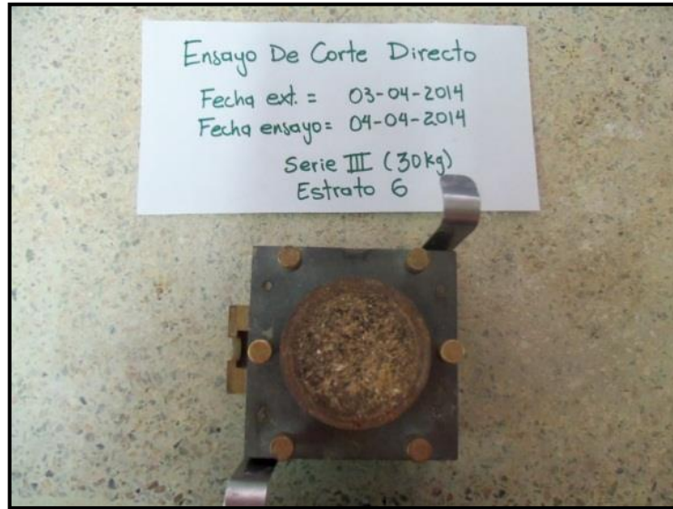
Fotografía 68. Anillo de corte con el espécimen sobre la caja de corte.
