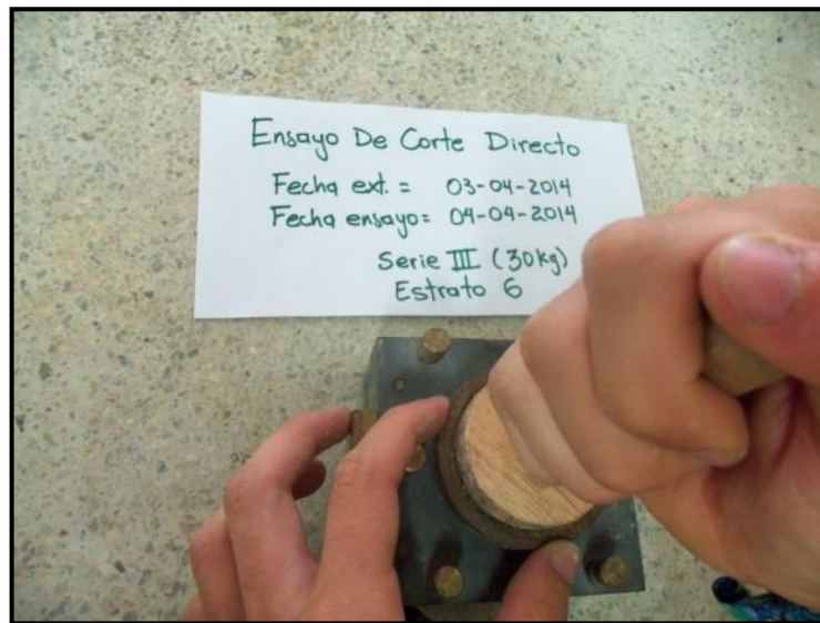
Fotografía 69. Espécimen de suelo expulsado del anillo de corte y depositado en la caja de corte.
