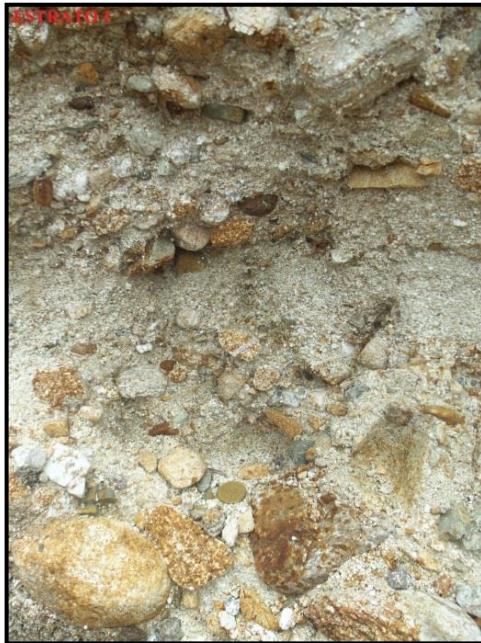
Fotografía 51. Estrato 1 de suelo que conforma el talud (conglomerado).
