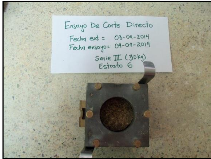
Fotografía 70. Espécimen de suelo dentro de la caja de corte.
