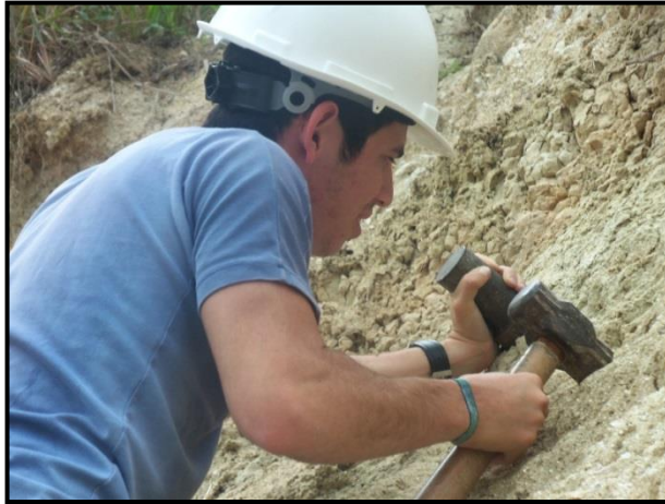
Fotografía 18. Extracción de la galleta de suelo.
