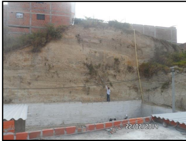
Fotografía 37. Toma de puntos con el bastón aplomador con prisma.
