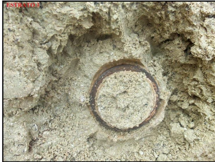
Fotografía 53. Estrato 3 de suelo que conforma el talud (arcillolita).
