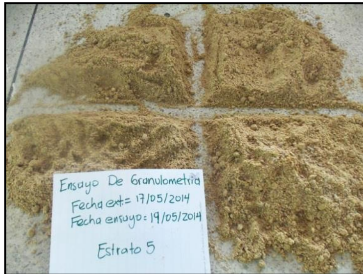
Fotografía 83. Cuarteo de la muestra.
