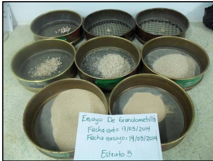
Fotografía 89. Muestra de suelo retenida en los tamices.
