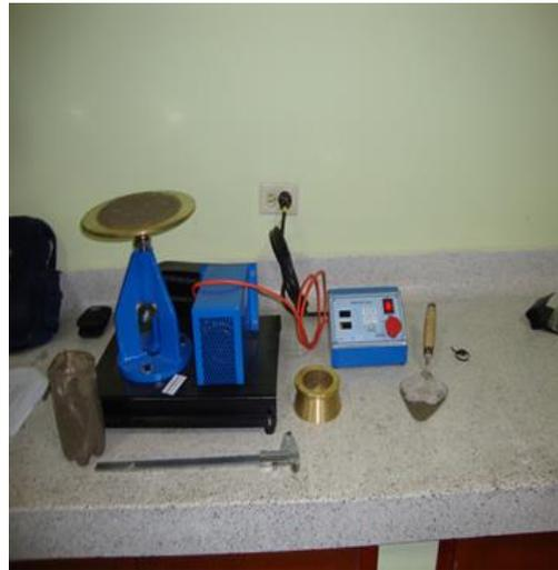
En las imágenes anteriores se puede observar el aumento de diámetro del mortero después de terminada la operación de mezclado durante un tiempo de 1 minuto, se procede a realizar el ensayo desde una altura de caída de 12.7mm (1/2") 25 veces durante 15 segundos, como se muestra en las fotografías 28 y 29.
