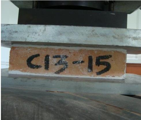
Fotografía 7. Ensayo modulo de rotura después del ensayo.
