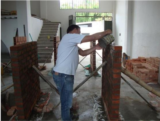
**Fotografía 40.** Muretes elaborados para ensayo de tracción diagonal
