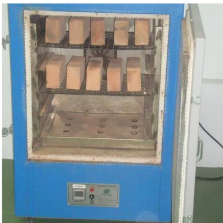
Fotografía 2. Horno digital de precisión a 110 °C
