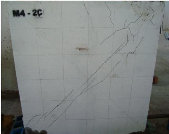
**Fotografía 63.** Falla por tracción diagonal murete reforzado. (Cara no reforzada)
