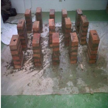
**Fotografía 33.** Ensayo resistencia a la compresión para prismas
