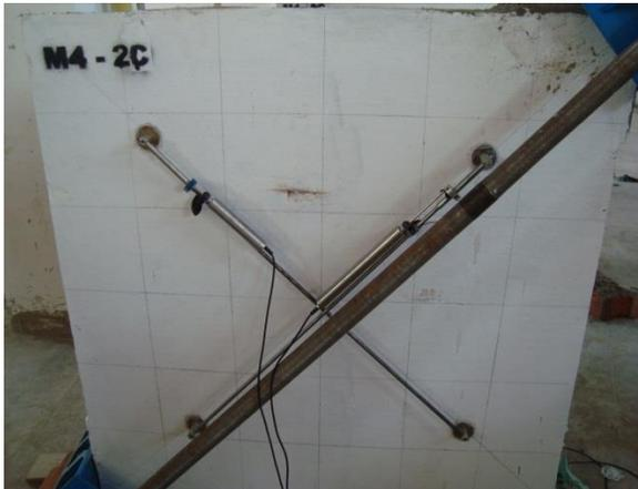
**Fotografía 55.** Instrumentación en la cara no reforzada
