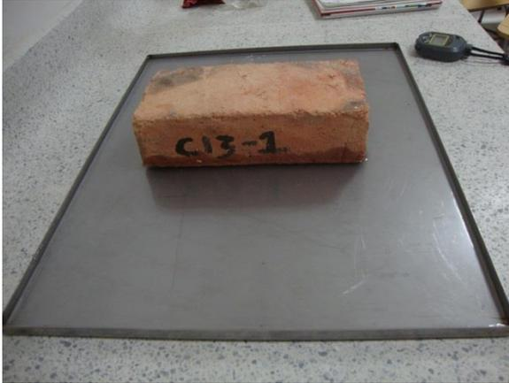
**Fotografía 18.** Determinación de la masa después de 60 segundos de absorción
