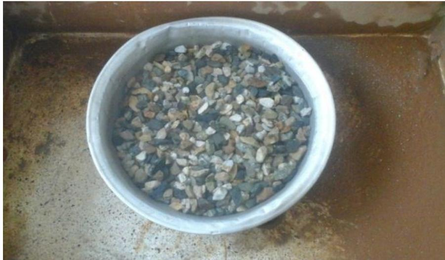
Figura 12. Preparación de muestra para ensayo de peso específico y absorción de agregados gruesos.
