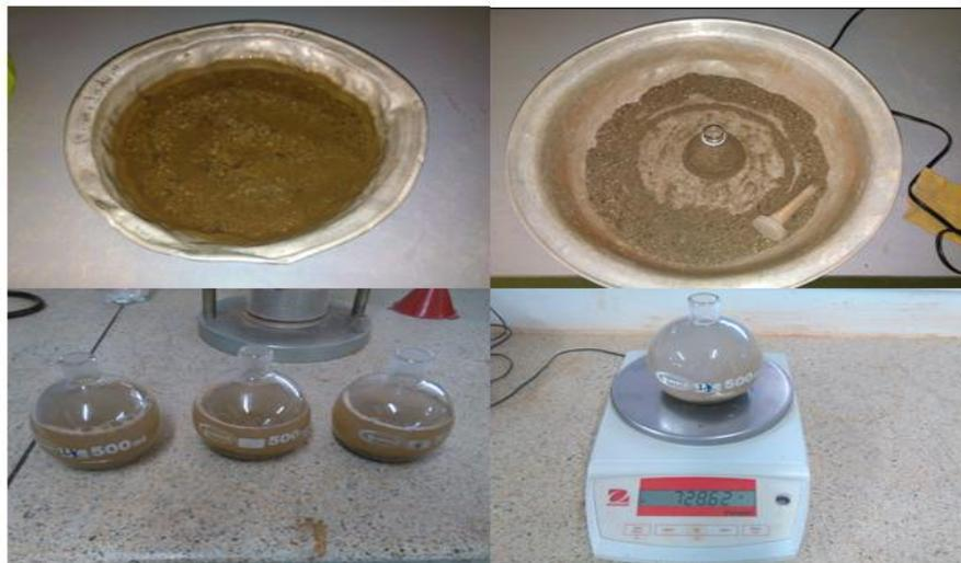
Figura 14. Determinación de la densidad y absorción de los agregados finos.
