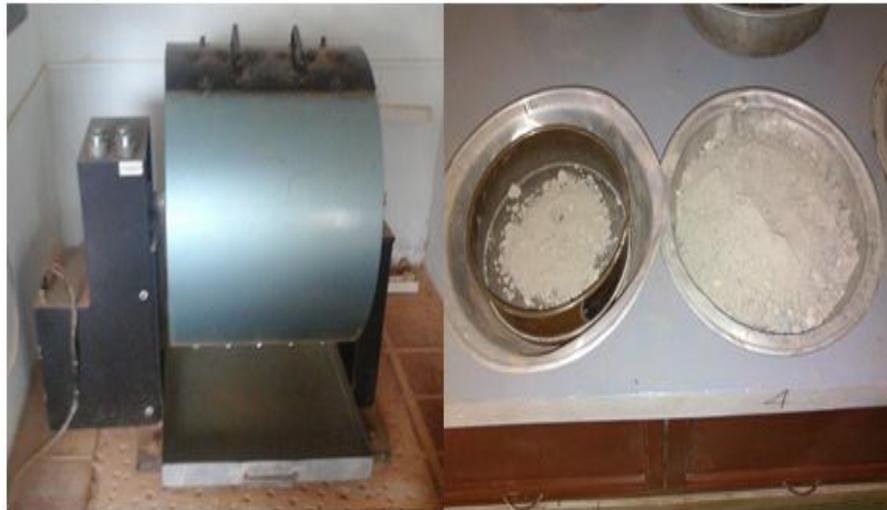
Figura 17. Máquina de los ángeles, ensayo de desgaste del agregado grueso.
