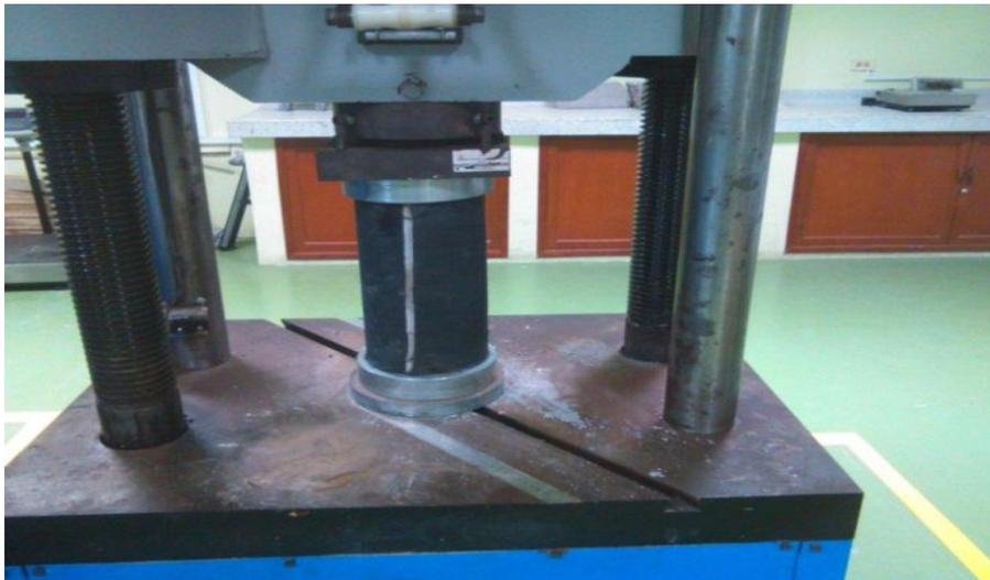
Figura 23 Ensayo de resistencia a la compresion.
