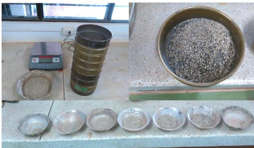
Figura 11. Granulometría de agregados.
