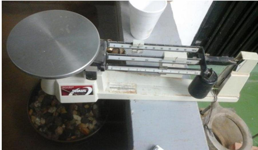
Figura 13. Toma del peso del agregado grueso sumergido en agua.
