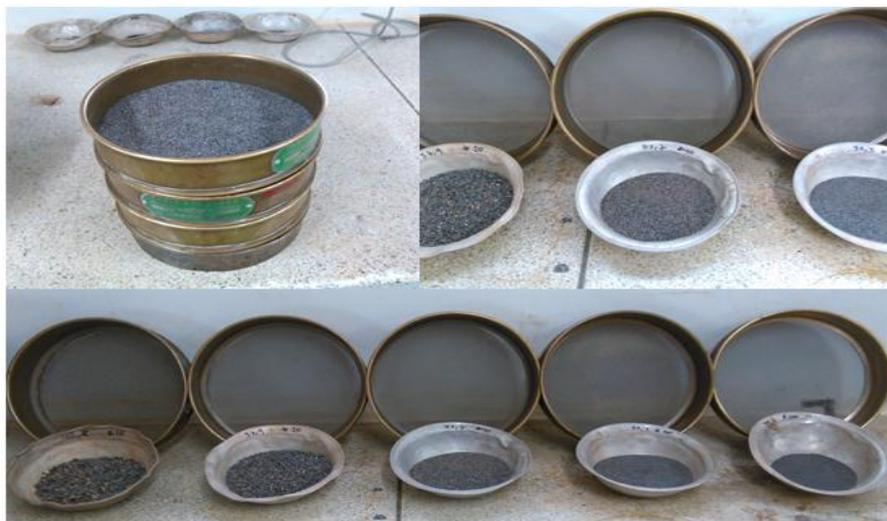
Figura 8. Granulometría de cenizas
