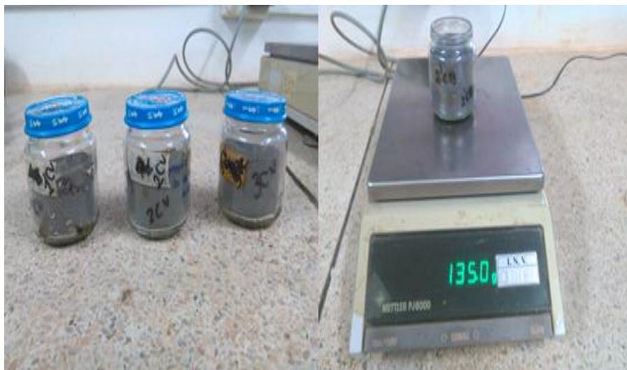
Figura 9. Determinación del contenido de humedad de las cenizas
