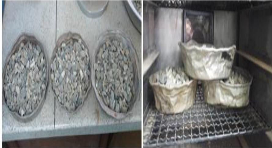
Figura 19. Determinación de la humedad en los agregados
