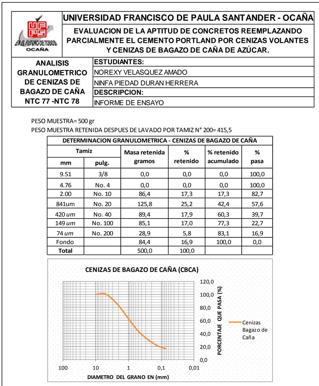
Las cenizas de bagazo de caña tienen un contenido bajo de material fino en comparación con las cenizas volantes, solo el 16,9 % pasa el tamiz N° 200.
