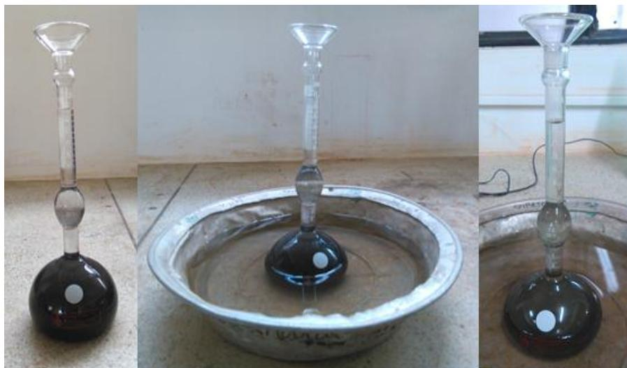
Figura 10. Determinación del peso específico de las cenizas
