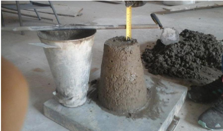
Figura 22. Ensayo de asentamiento.
