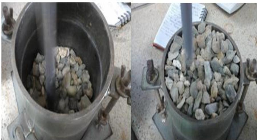
Figura 16. Determinación de masa unitaria compacta.
