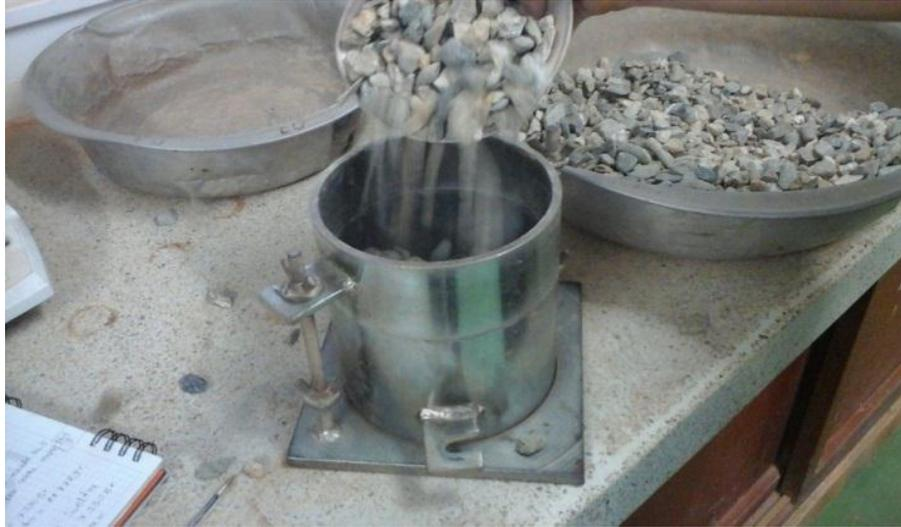
Figura 15. Determinación de masa unitaria suelta.
