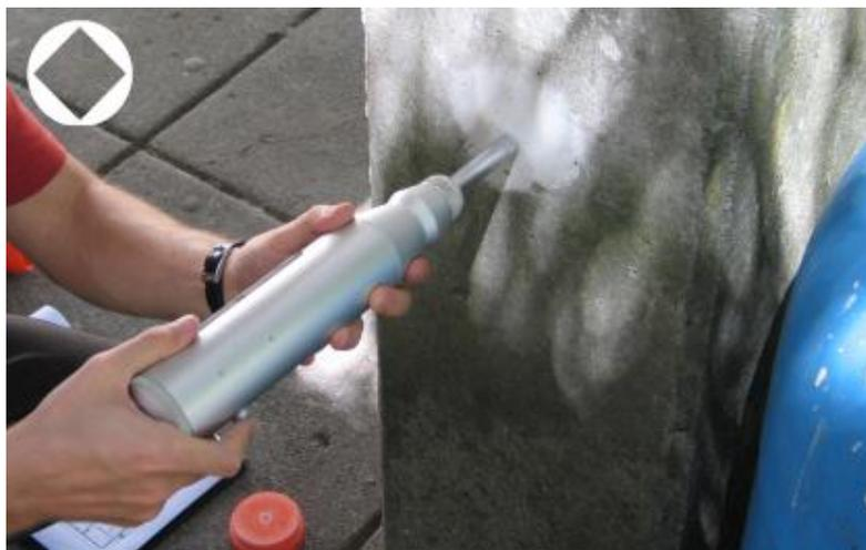
Figura 3. Ensayo de esclerometría. Fuente: NCREP (2011).
