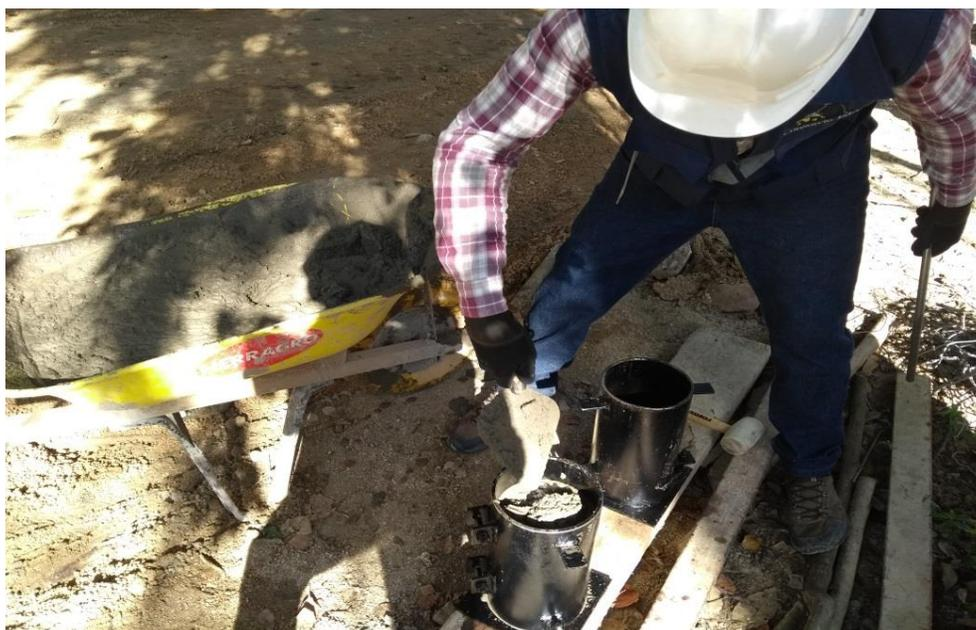
**Fotografía 27.** Elaboración de especímenes de concreto.
