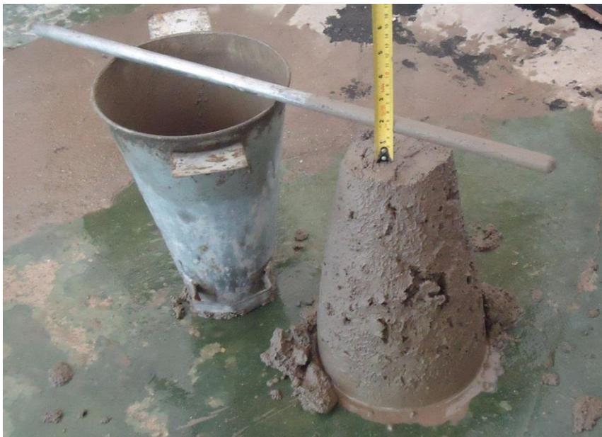
**Fotografía 33.** Ensayo de sentamiento del concreto.
