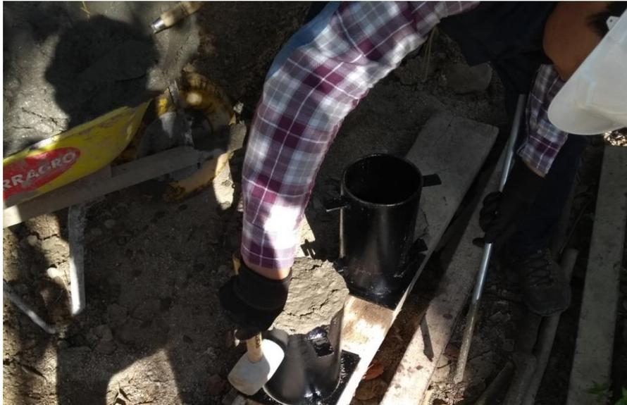
**Fotografía 28.** Elaboración de especímenes de concreto.
