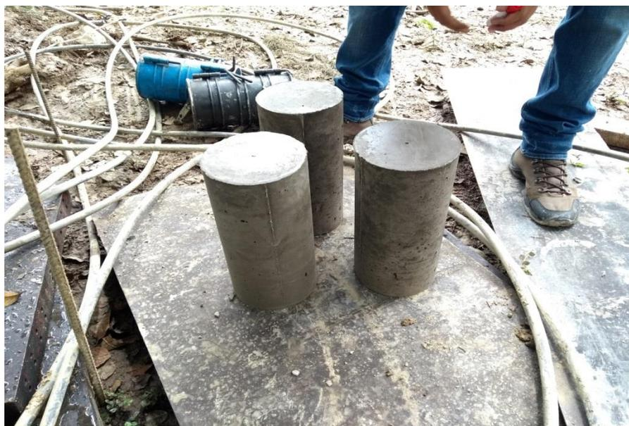
**Fotografía 26.** Especímenes de concreto terminados.
