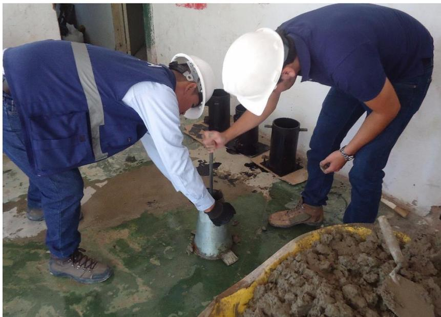
**Fotografía 32.** Ensayo de asentamiento del concreto.
