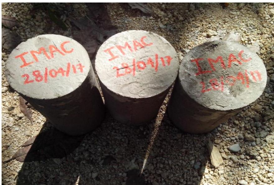
**Fotografía 29.** Especímenes de concreto terminados y marcados.
