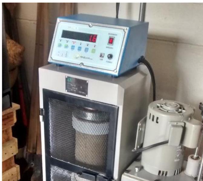
**Fotografía 31.** Ensayo de compresión de concreto.
