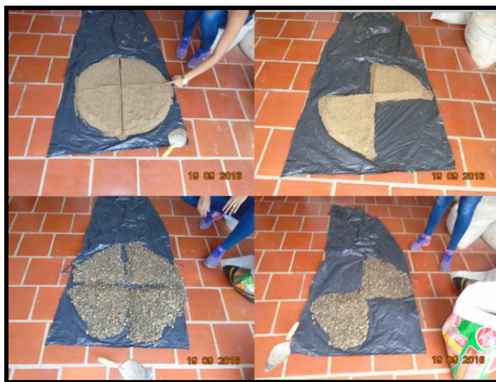
Figura 5. Obtención de muestras por cuarteo.
