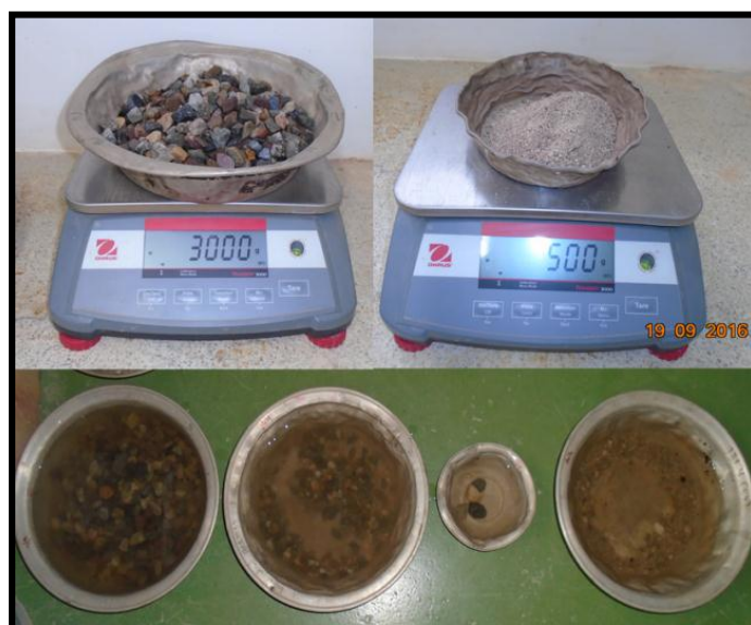
Figura 14. Determinación de los terrones de arcilla y partículas deleznales en los agregados.
