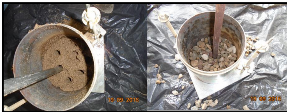
Figura 11. Masa unitaria compacta de los agregados.
