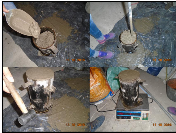
Figura 25. Determinación peso unitario del concreto fresco.
