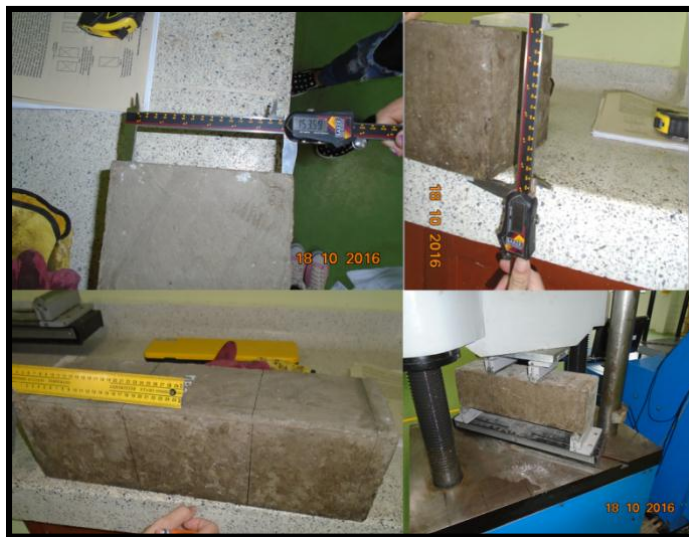
Figura 29. Preparación de la viga de concreto
