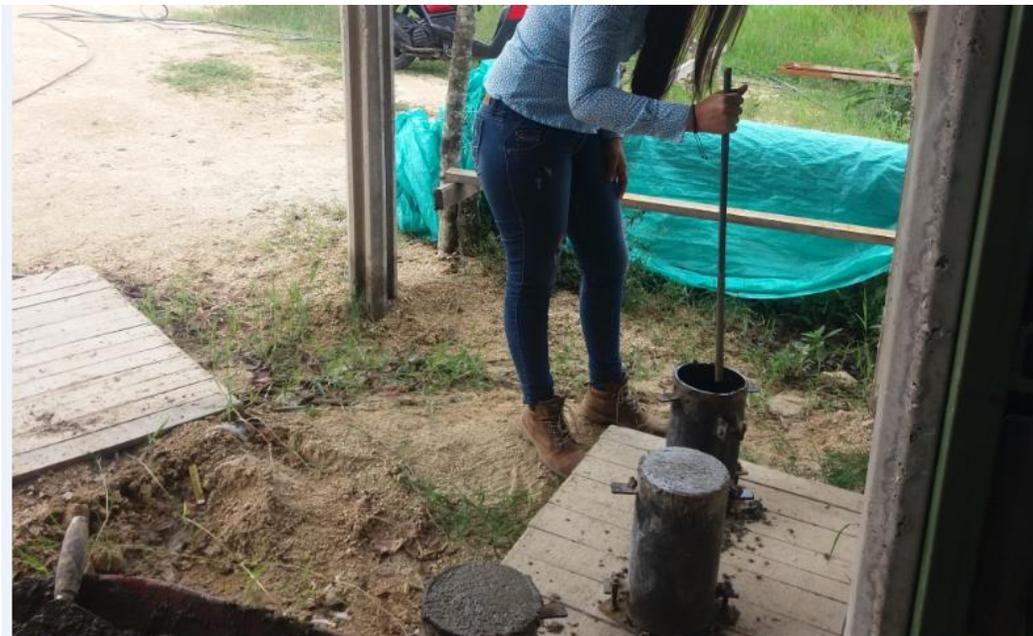
**Imagen 38.** Elaboración de cilindros para ensayo de resistencia a la compresión del concreto
