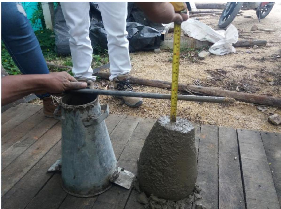
**Imagen 36.** Ensayo de Asentamiento
