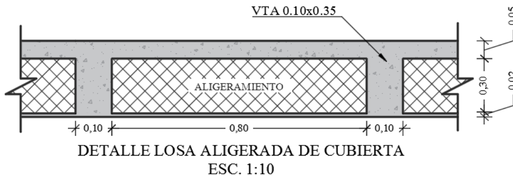
Figura 4. Detalle losa aligerada de cubierta.
