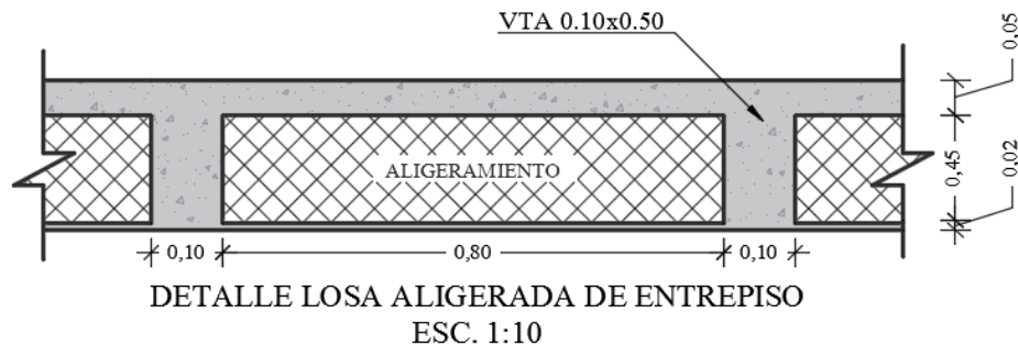
Figura 3. Detalle losa aligerada de entrepiso (pisos 1-2-3-4).
