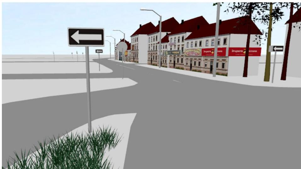
Figura 81. Ejemplo de instalación de la señal SR-38 SENTIDO UNICO DE CIRCULACIÓN, para la intersección Crediservir
