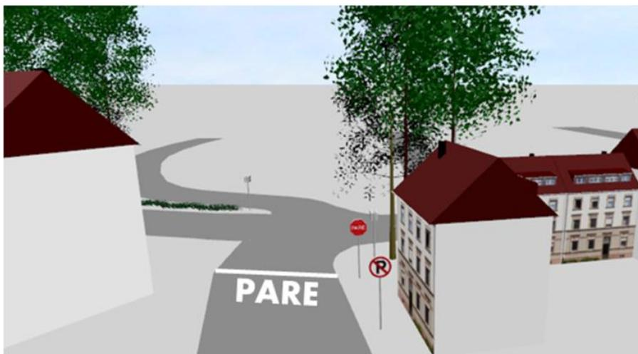
Figura 83. Ejemplo de demarcación para el cruce controlado por señal PARE. Intersección “Droguería Alemana”
