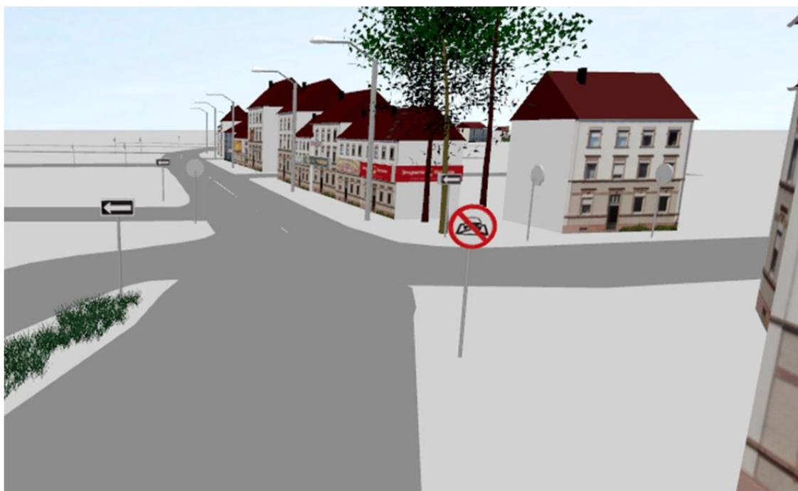
Figura 79. Ejemplo de instalación de la señal vertical SR-47 NO BLOQUEAR CRUCE, para la vía principal, en sentido Sur-Norte.
