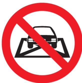
Figura 78. Señal Vertical SR-47 NO BLOQUEAR CRUCE
