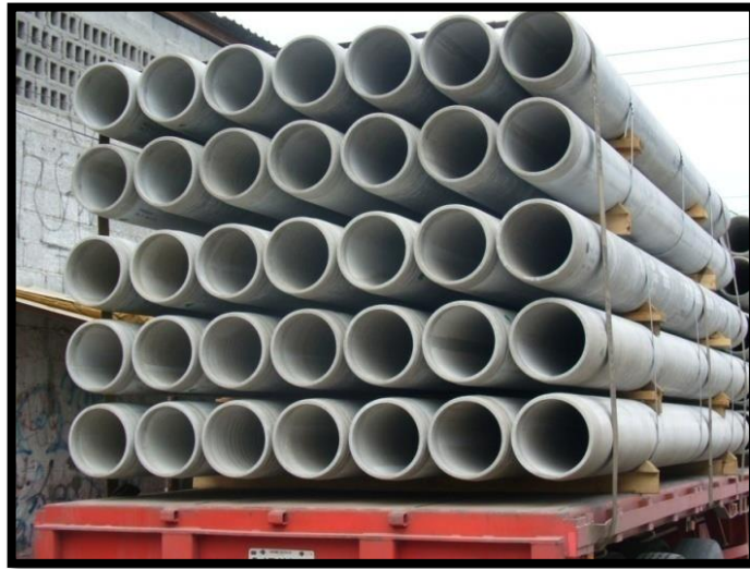
Fotografía N° 1. Tubería Asbesto Cemento
