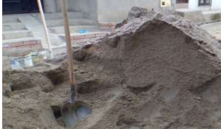
Foto 44. Arena utilizada en la elaboración del concreto
