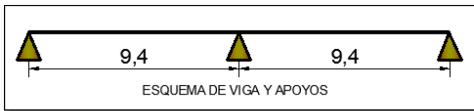
Figura 24. Esquema de viga y apoyos para el nuevo diseño. Fuente: Autor de la pasantía.
