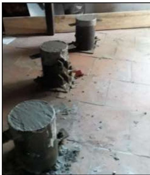
Figura 6. Acabado de los especímenes de concreto. Fuente: Autor de la pasantía.
