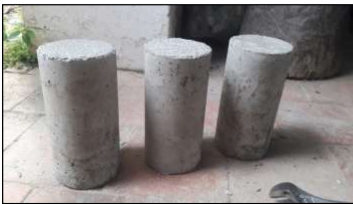
Figura 7. Especímenes de concreto desencofrados. Fuente: Autor de la pasantía.
