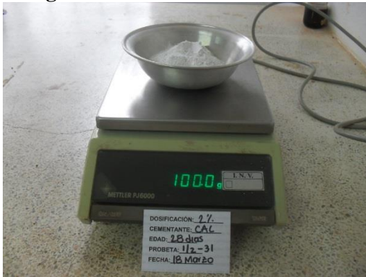
Fotografía 36. Cal a adicionar.
