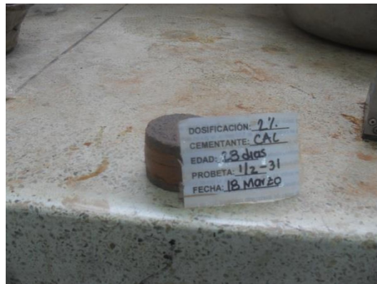
Fotografía 51. Falla 2% de cal a 28 días.
