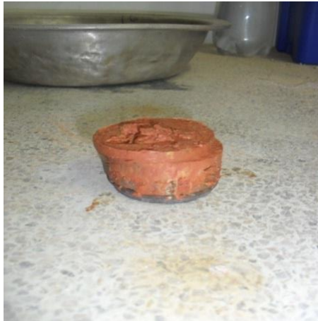
Fotografía 16. Falla de la muestra debido a la acción de corte directo.
