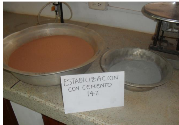
Fotografía 78. Suelo-cemento a mezclar.
