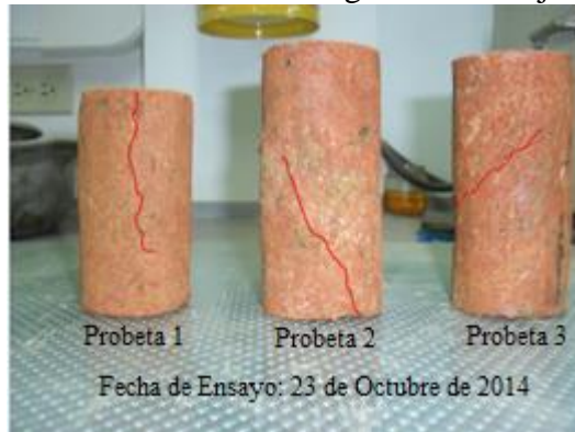
Fotografía 18. Falla de las muestras debido a cargas axiales bajo compresión simple.
