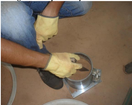
Fotografía 79 y 80. Rayado de cara entre capas.
