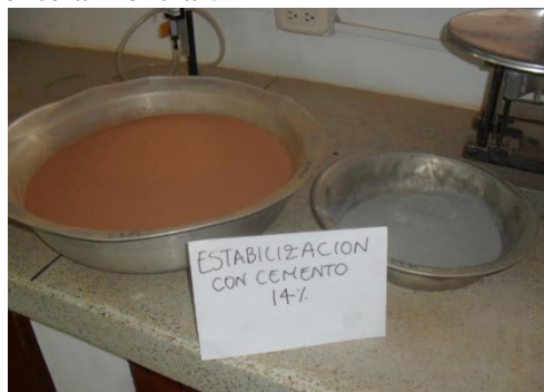
Fotografía 91. Suelo-cemento a mezclar.
