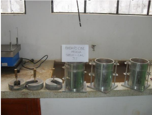
Fotografía 30. Moldes para el ensayo de CBR.
