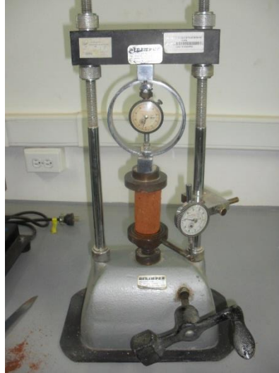
Fotografía 17. Montaje de la muestra en máquina de compresión simple.
