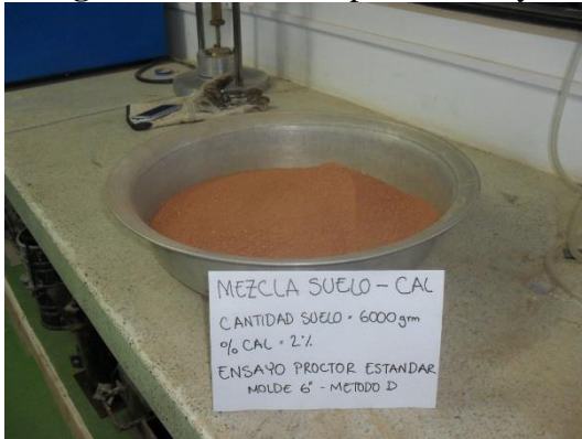
Fotografía 23. Muestra para el ensayo de proctor. Fotografía 24. Cal a adicionar.
