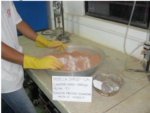
Fotografía 25. Mezcla de suelo-cal.
