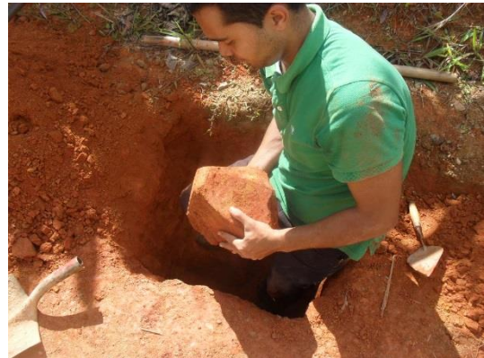
Fotografía 5 y 6. Muestras inalteradas para determinar la resistencia y deformación del suelo.
