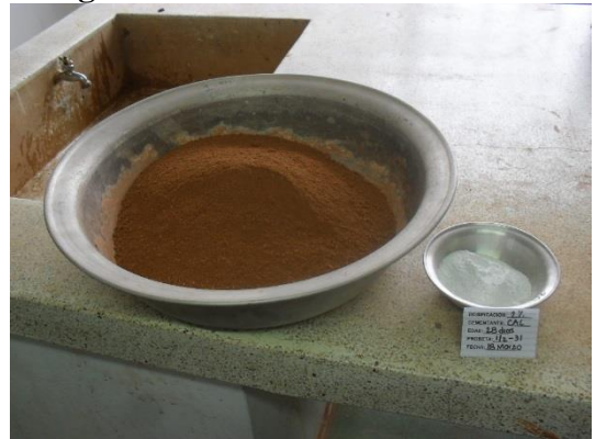
Fotografía 37. Suelo-cal a mezclar.
