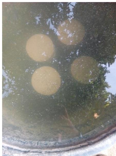
Figura 125. Curado de los cilindros
