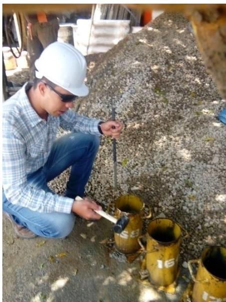
Figura 120. Preparación de cilindros Metálicos.
