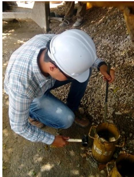
Figura 11. Toma de muestra concreto.
