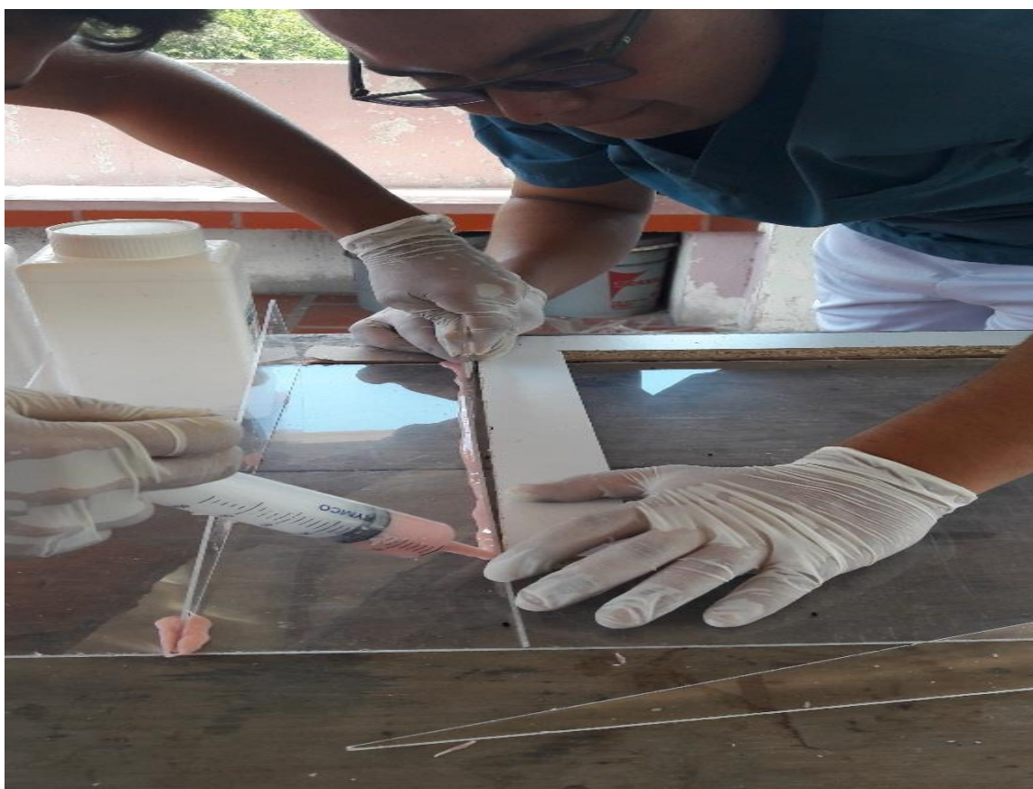
Figura 14 Montaje de secciones de canal Etapa Inicial Tercer Paso Nota fuente: Autores del proyecto
