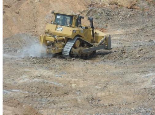
La hoja topadora de esta máquina es una semi-universal con capacidad de 8,7M<sup>3</sup>, la profundidad máxima de excavación del desgarrador es 1130mm.
