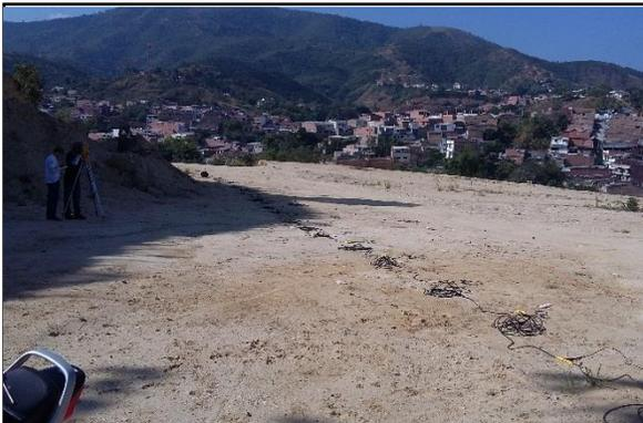
Montaje de la línea de adquisición
