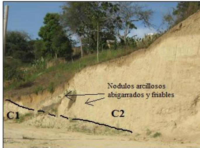
Figura 17. Presencia de nódulos arcillosos en los estratos conglomeraticos.
