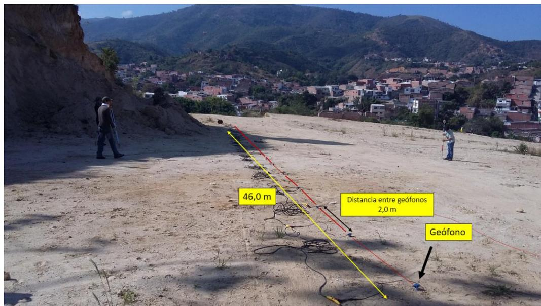
Figura 37. Disposición de los geófonos en campo.
