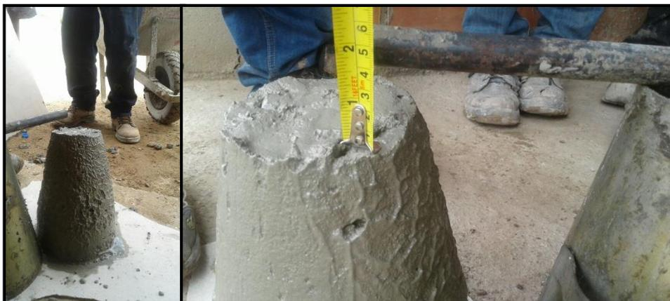
*Figura 25.* Ensayo para determinar el asentamiento con cono.
