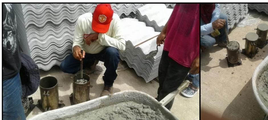
*Figura 26.* Toma de muestras para determinar resistencia del concreto
