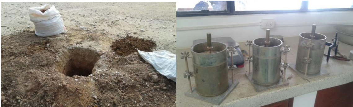
Figura 67. Toma de muestras en zona de estudio y realización de CBR en laboratorio de suelos UFPSO. Nota fuente: Autores 2017.
