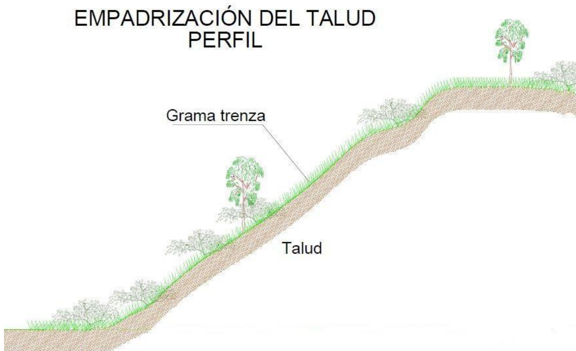
Figura 88. Detalle en perfil empadricación del talud.
