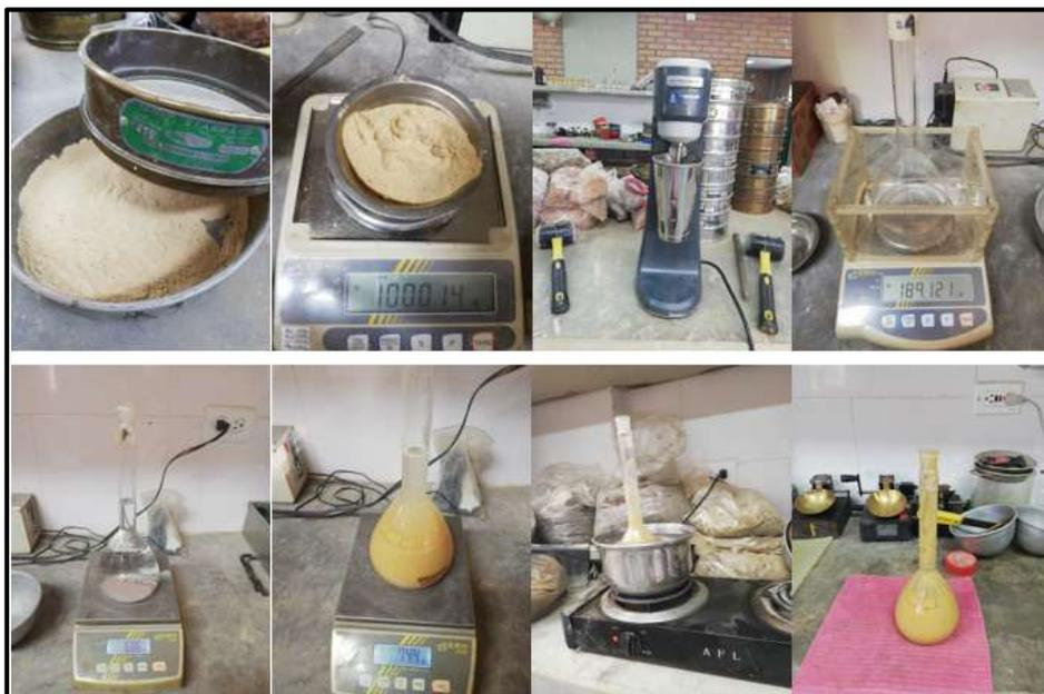
*Figura 82* Ensayo de gravedad específica de la arcilla en su estado natural
