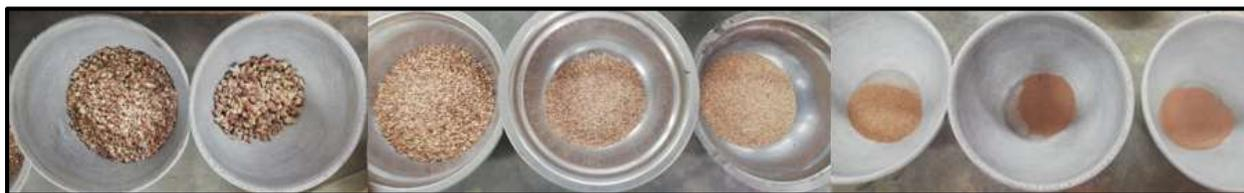
*Figura 85* Granulometría del agregado fino.
