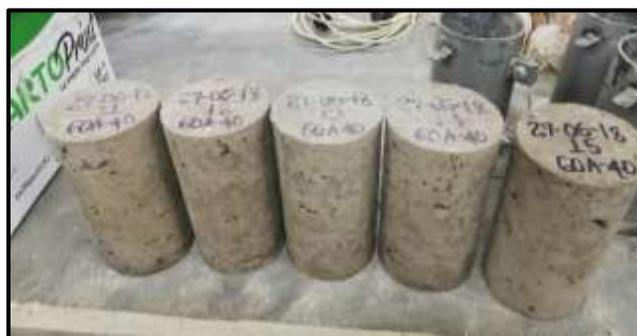
*Figura 95* Marcar los cilindros para su identificación
