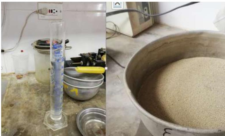
*Figura 83* Ensayo de límite líquido de la arcilla en su estado natural
