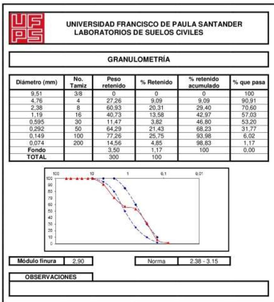
Figura 39 Granulometría de la mezcla 50:50 de arcilla calcinada
