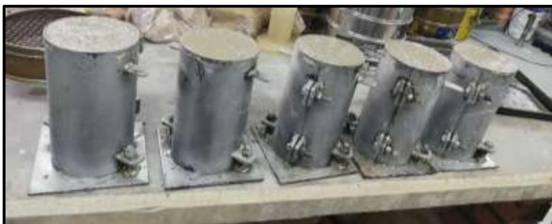
*Figura 94* Cilindros de las mezclas de concreto
