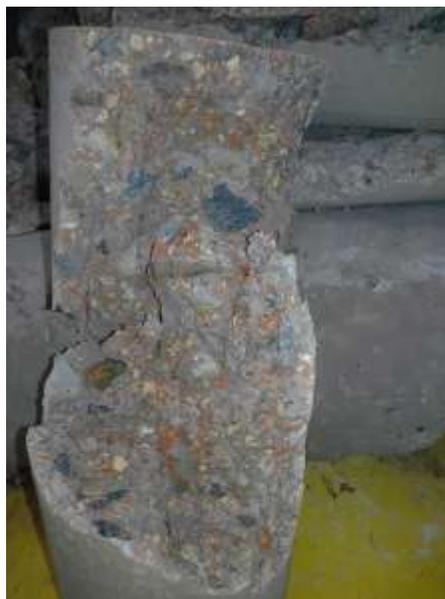
*Figura 98* Falla de los cilindros
