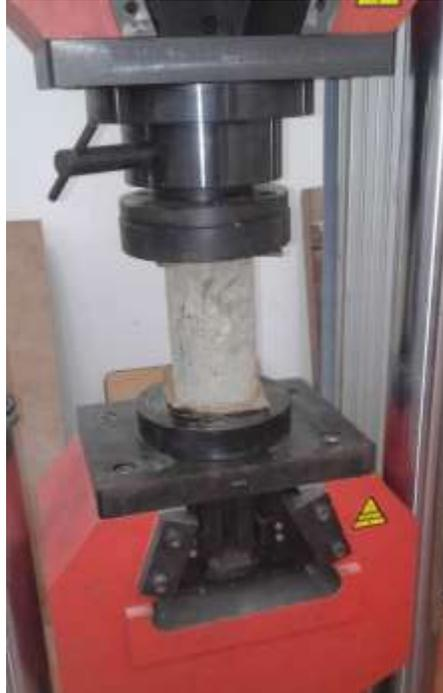
*Figura 97* Ensayo de compresión de los cilindros
