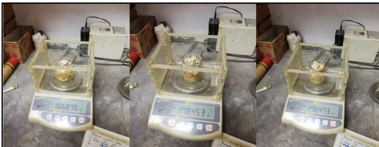
*Figura 76* Ensayo de humedad de la arcilla en su estado natural
