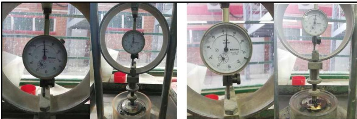
*Figura 80* Ensayo de presión de Lambe de la arcilla en su estado natural
