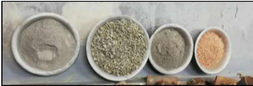
*Figura 900* Materiales para la mezcla de concreto con adición de arcilla
