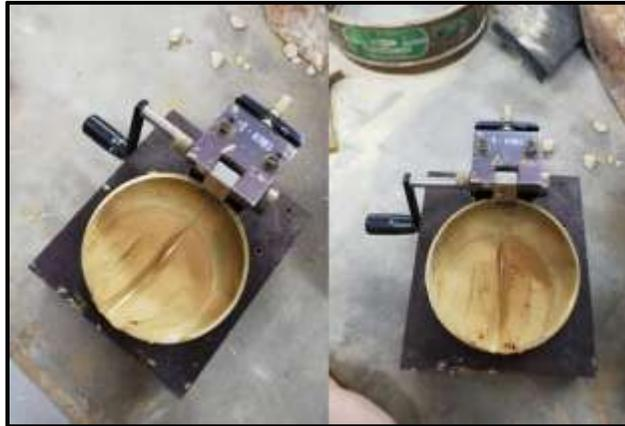
*Figura 77* Ensayo de límite líquido de la arcilla en su estado natural
