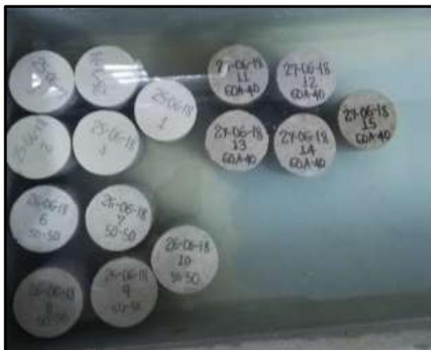
*Figura 96* Sumergir los cilindros para su posterior ensayo.
