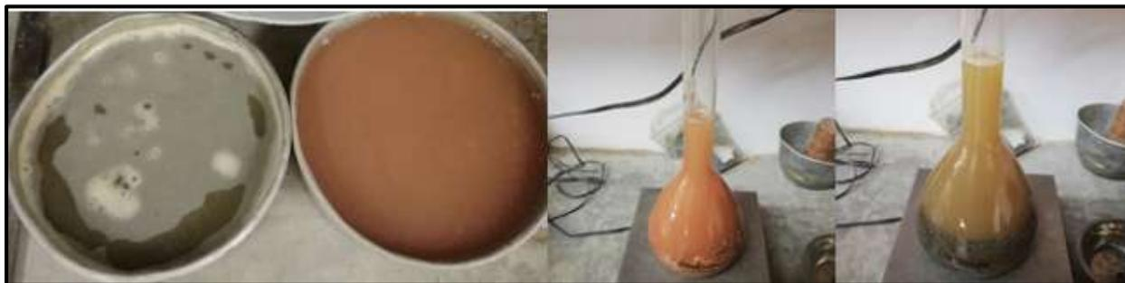
*Figura 88* Densidad y absorción del agregado fino.
