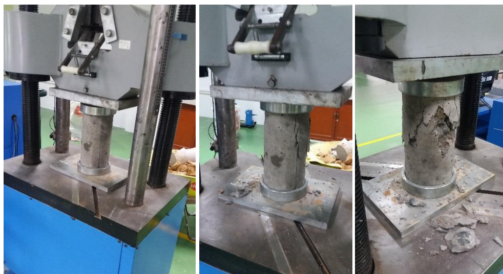
Figura 85. Ensayo de resistencia a la compresión del concreto.
