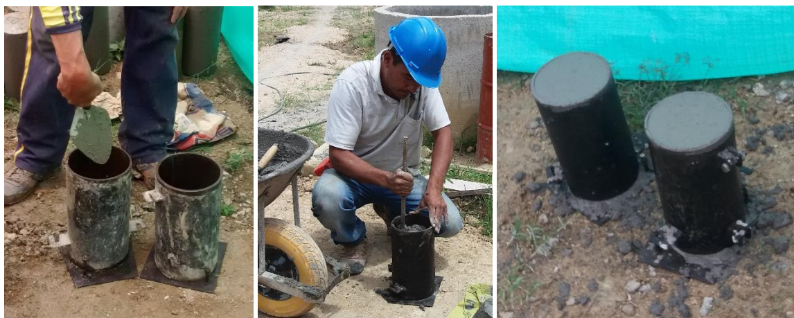
Figura 83. Ensayo de resistencia a la compresión del concreto.
