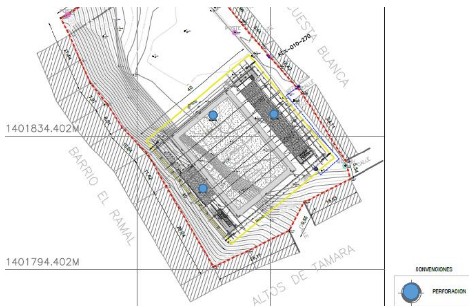
Figura 7. Ubicación de perforaciones.
