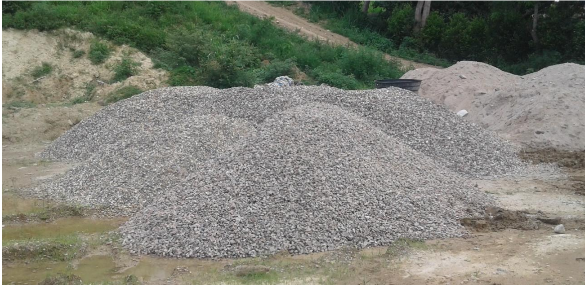
Figura 81. Condiciones de almacenamiento del agregado grueso.
