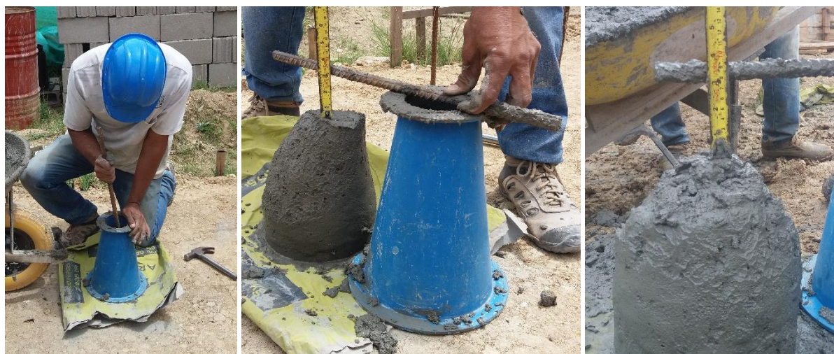
Figura 86. Ensayo de asentamiento del concreto.
