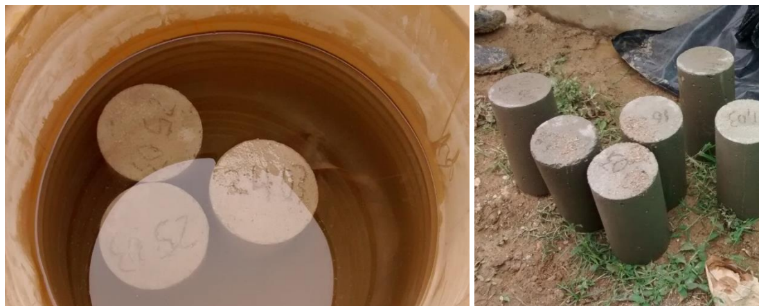
Figura 84. Ensayo de resistencia a la compresión del concreto.
