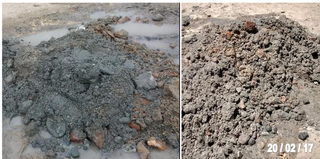
Figura 37. Apariencia del material excavado para pilas en el sector oriental.
