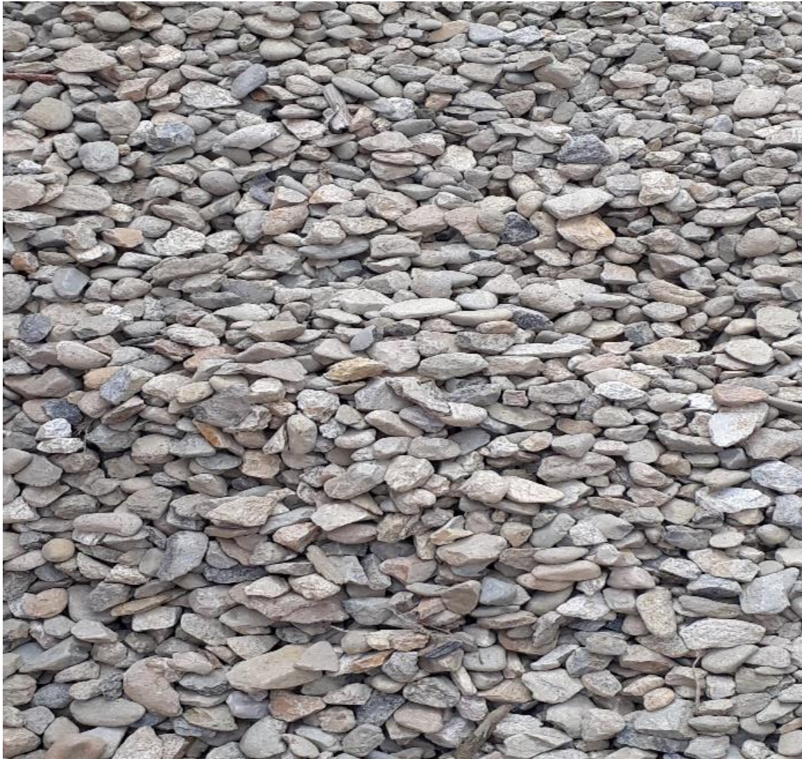
Figura 10. Agregado grueso utilizado en obra.
