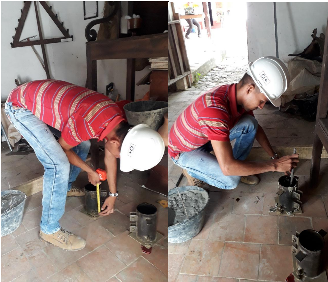
Figura 14. Elaboración de los cilindros para ensayo a compresión.
