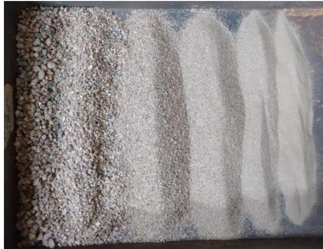
Figura 73. Granulometría de la arena del río Algodonal.
