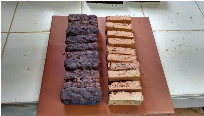
Figura 69. Probetas sinterizadas de las muestras Cúcuta-Ocaña.
