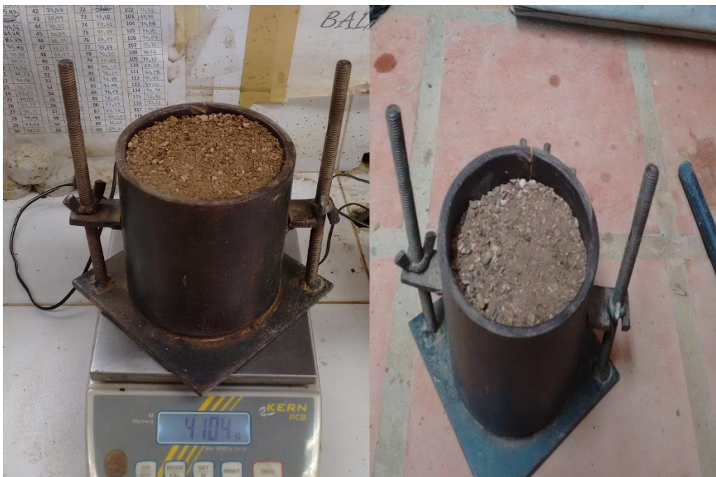
Figura 76. Masa unitaria suelta y compactada de la arcilla expandida de Ocaña.
