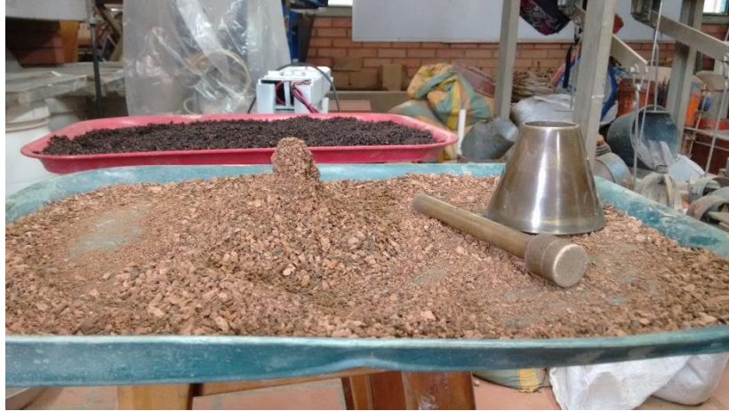
Figura 79. Muestra saturada superficialmente seca de la arcilla expandida de Ocaña.
