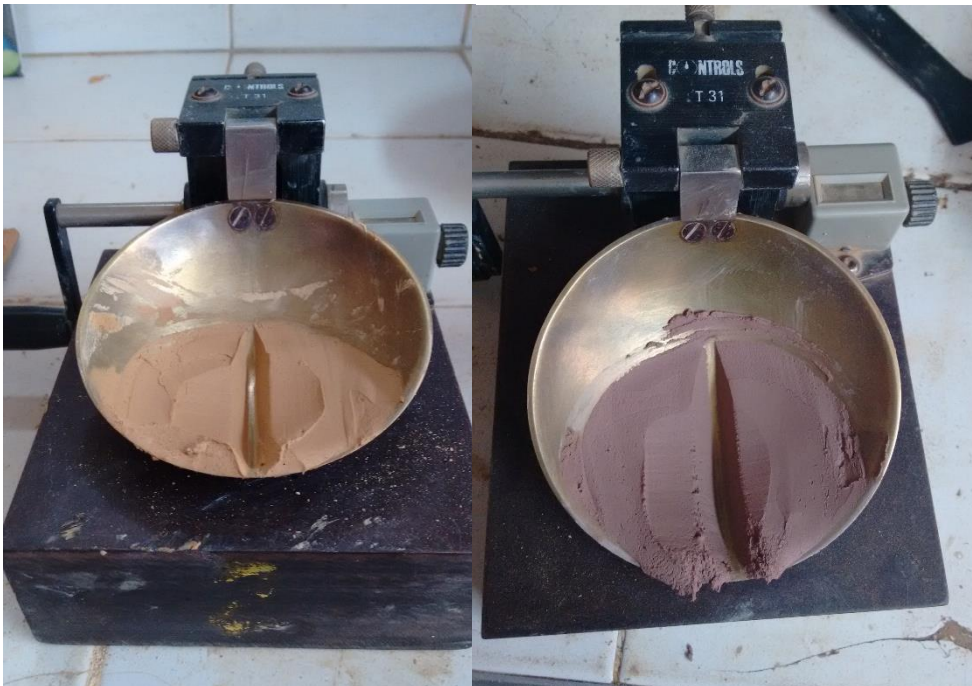
Figura 58. Límite líquido de las muestras Ocaña-Cúcuta.
