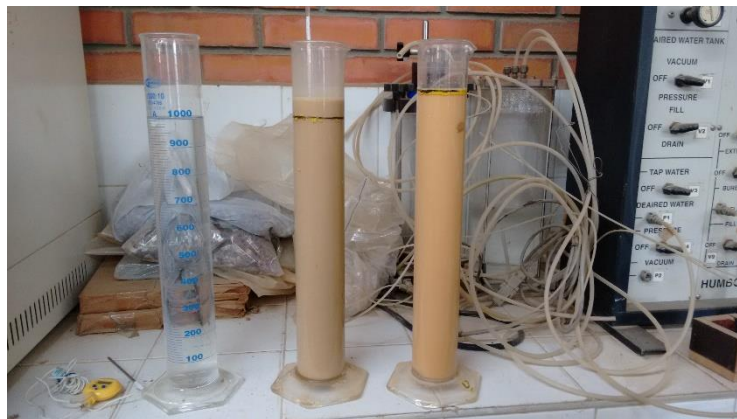
Figura 64. Granulometría por medio del hidrómetro de las muestras Cúcuta-Ocaña.
