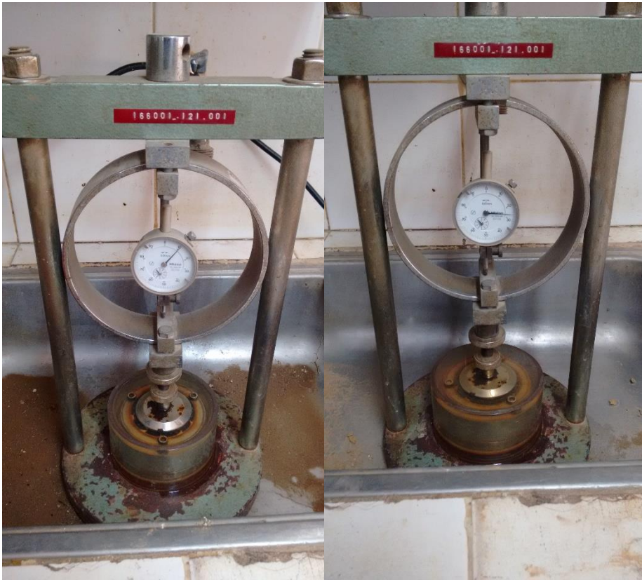
Figura 61. Presión de expansión de Lambe de las muestras Ocaña-Cúcuta.
