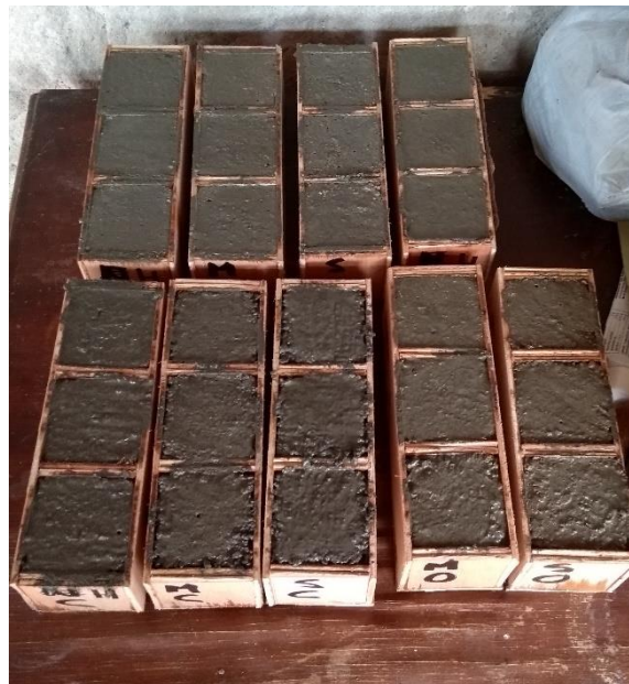
Figura 87. Llenado de los moldes con la mezcla de mortero.
