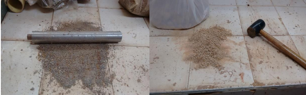
Figura 65. Disgregación de las muestras de arcillas Cúcuta-Ocaña.
