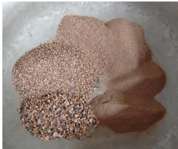
Figura 33. Granulometría de arcilla expandida de Ocaña. Nota fuente. Autores del proyecto.
