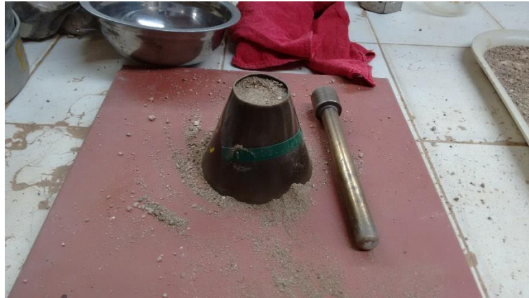
Figura 77. Muestra saturada superficialmente seca de la arena del rio Algodonal.
