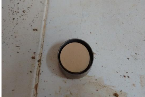
Figura 60. Límite de contracción.
