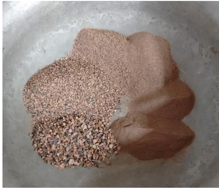
Figura 71. Granulometría de la arcilla expandida de Ocaña.
