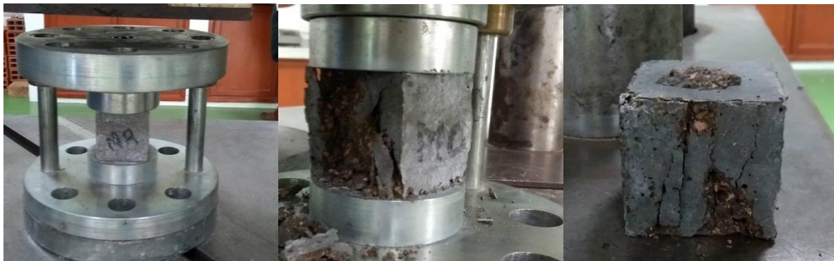
Figura 91. Ensayo de resistencia a la compresión de morteros.
