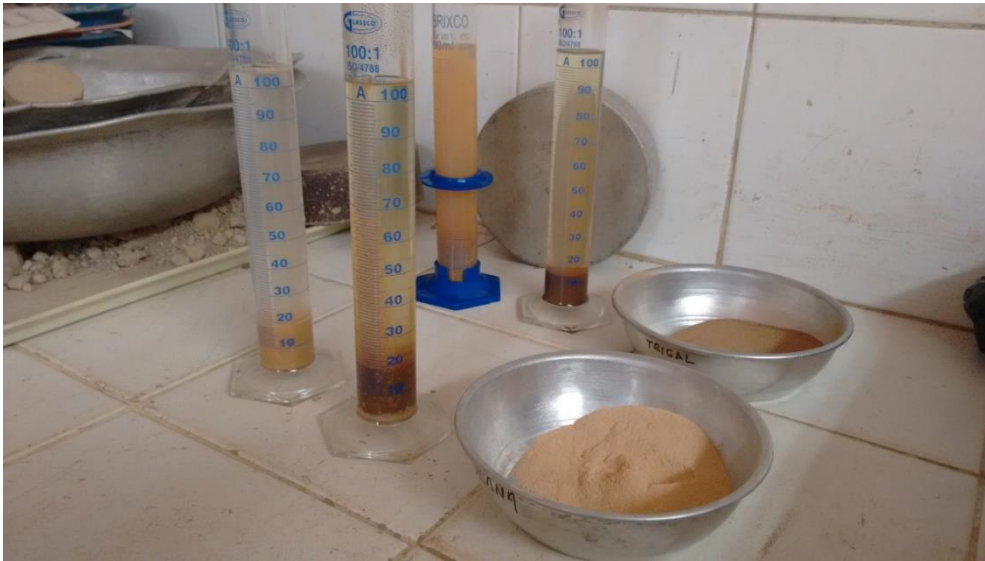
Figura 62. Expansión libre en probeta.
