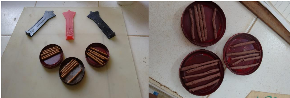
Figura 59. Límite plástico de las muestras Ocaña-Cúcuta.
