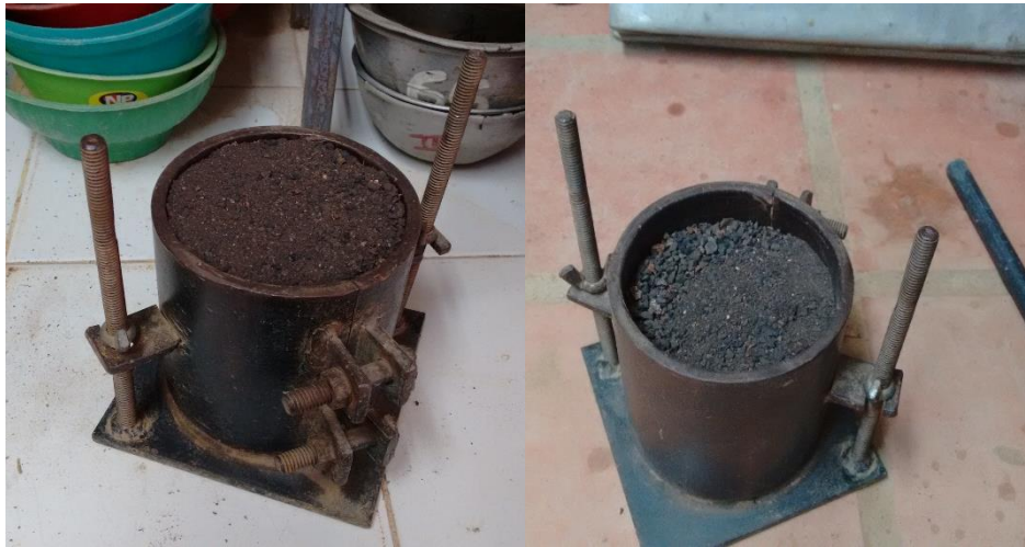
Figura 75. Masa unitaria suelta y compactada de la arcilla expandida de Cúcuta.
