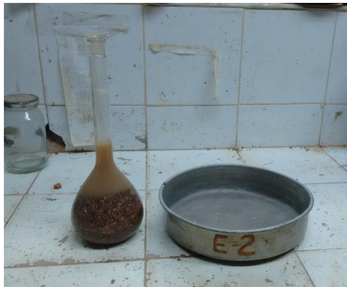
Figura 80. Picnómetro más agua hasta la calibración de la arcilla expandida de Ocaña.
