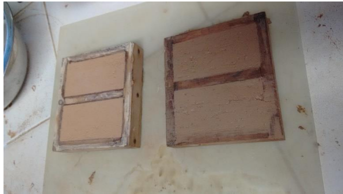
Figura 23. Encofrado de las probetas de las muestras Ocaña-Cúcuta. Nota fuente. Autores del proyecto.
