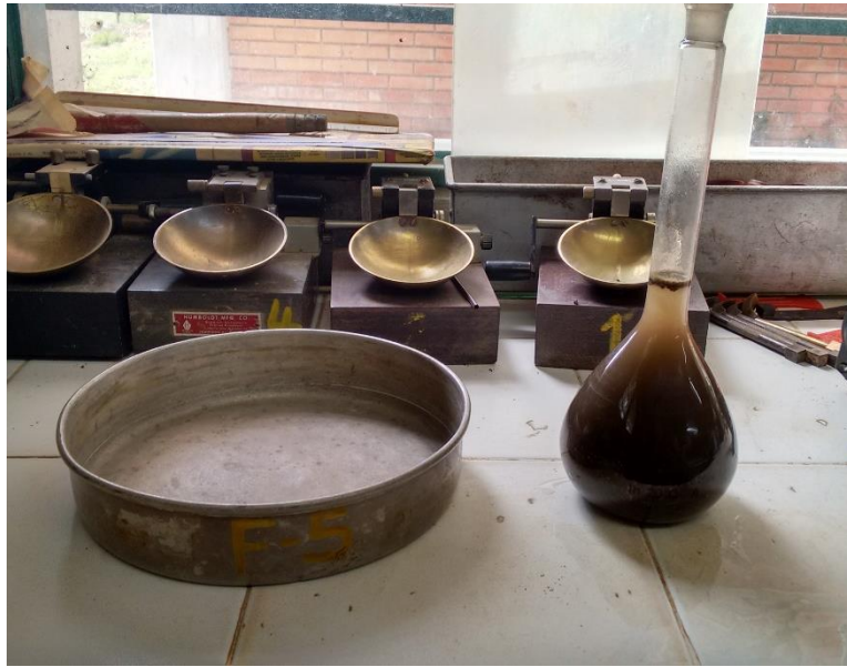
Figura 81. Picnómetro más agua hasta la calibración de la arcilla expandida de Cúcuta. Nota fuente. Autores del proyecto.
