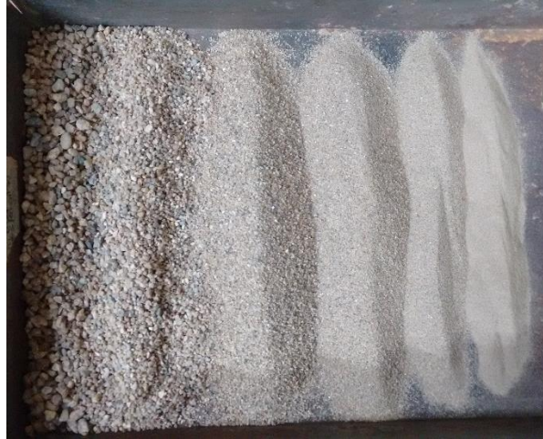
Figura 32. Granulometría de la arena del río Algodonal. Nota fuente. Autores del proyecto.
