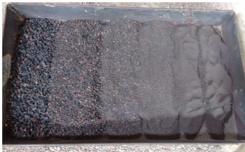
Figura 72. Granulometría de la arcilla expandida de Cúcuta.
