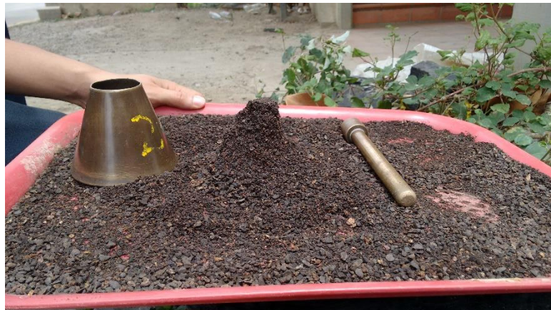
Figura 78. Muestra saturada superficialmente seca de la arcilla expandida de Cúcuta.
