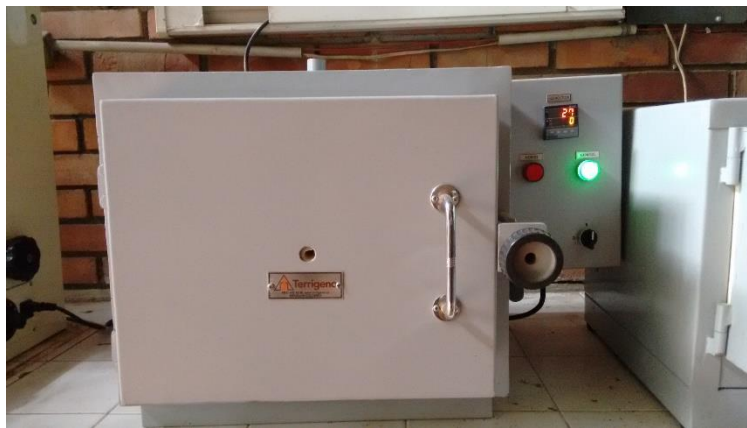
Figura 68. Mufla que alcanza la temperatura de 1200°C.
