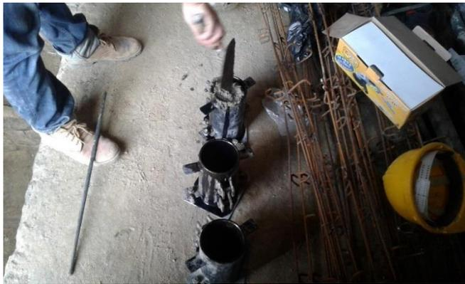
Figura 22. Toma de cilindros para pruebas de compresión.
