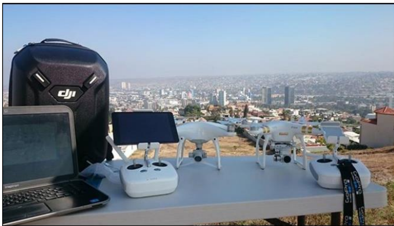
Figura 43. Equipo usado en el levantamiento fotogramétrico
