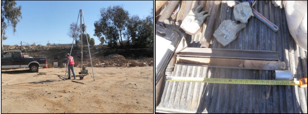
Figura 35. Primer sondeo con prueba de penetración estándar y su respectiva muestra
