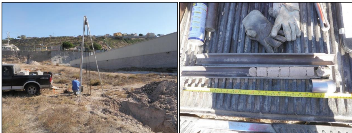
Figura 37. Sondeo 3 con prueba de penetración estándar y su respectiva muestra
