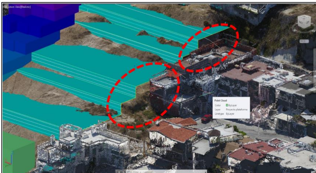
Figura 54. Rellenos que requieren de estructuras de contención.
