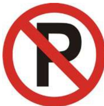
Figura 20. Señal vertical SR-28 PROHIBIDO PARQUEAR. Fuente: (Instituto nacional de vías, 2015).
