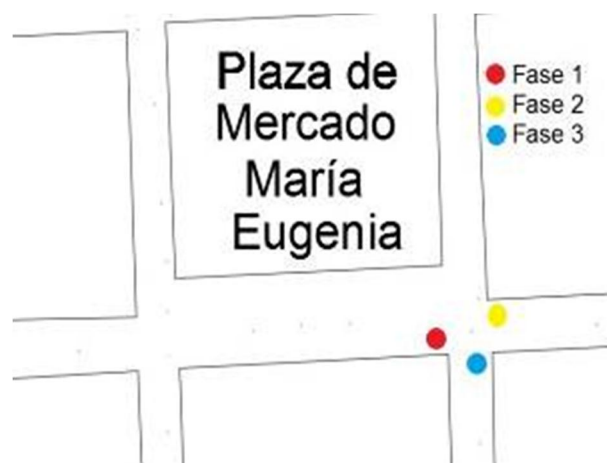
Figura 17. Fases semaforica sobre la calle 2ª con carrera 31. Fuente: autores del proyecto.
