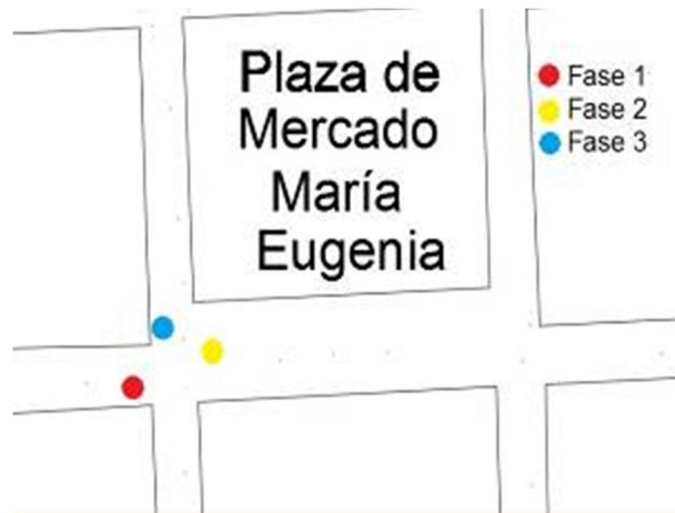
Figura 16. Fases semaforica sobre la calle 2ª con carrera 30. Fuente: autores del proyecto.
