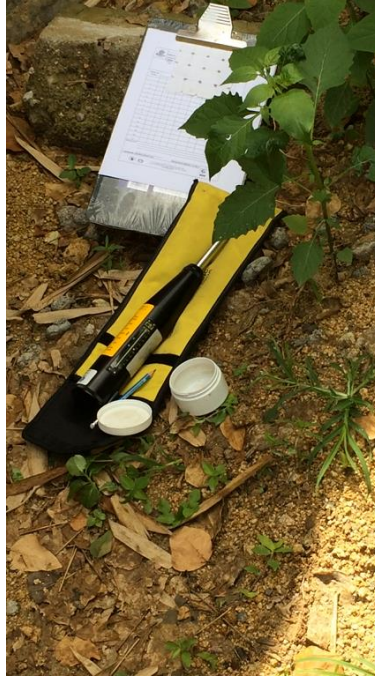
Fotografía 2. Implementos necesarios para realizar la prueba de esclerometría.
