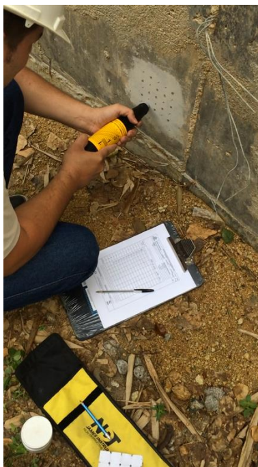
Fotografía 11. Chequeo de rebote en un punto para el registro de resultados.
