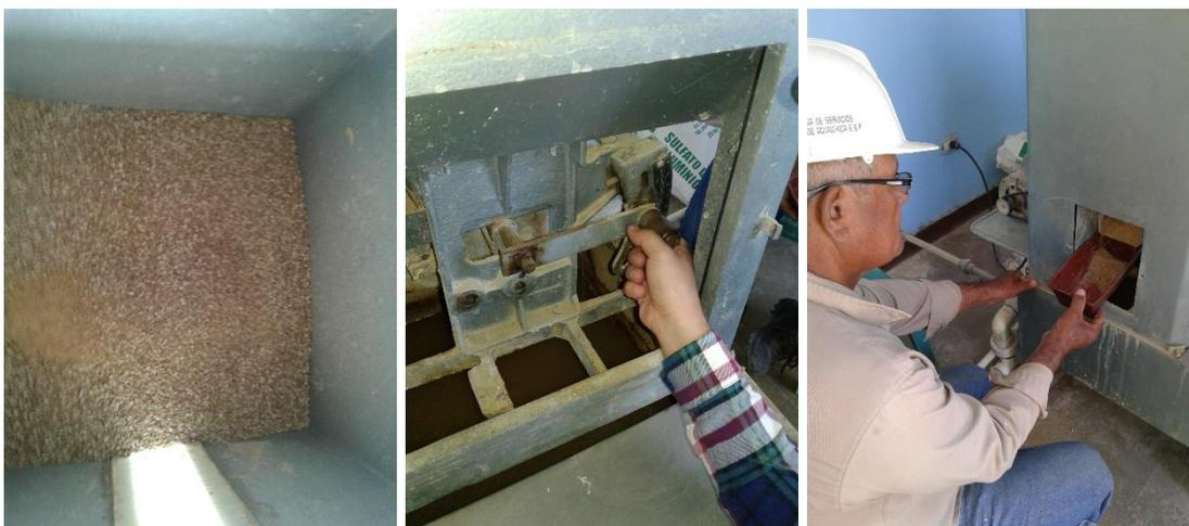
Fotografía 19. Calibración de la tolva dosificador.
