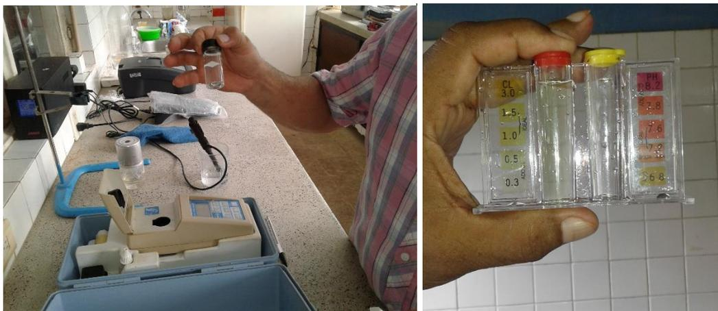
Fotografía 38. Determinación de Turbidez y cloro del agua en la planta de tratamiento
