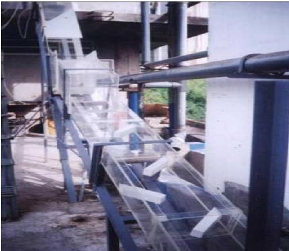
**Figura 13.** Canal de pantallas deflectoras (Modelo experimental)
