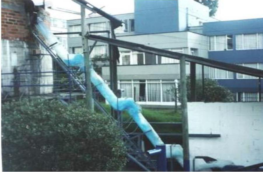
**Figura 14.** Canal de rápidas con tapa y columpio (Modelo experimental)
