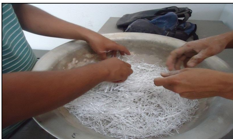
Figura 32. Fibra de polipropileno para mezclar con concreto. Fuente: Autores del proyecto.
