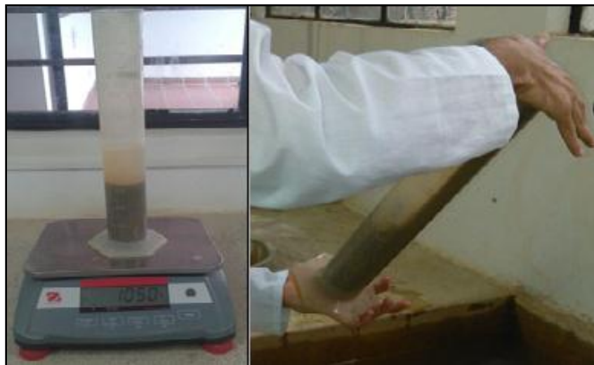
Figura 12. Ensayo de gravedad específica y absorción de agregado fino. Fuente: Autores del proyecto.
