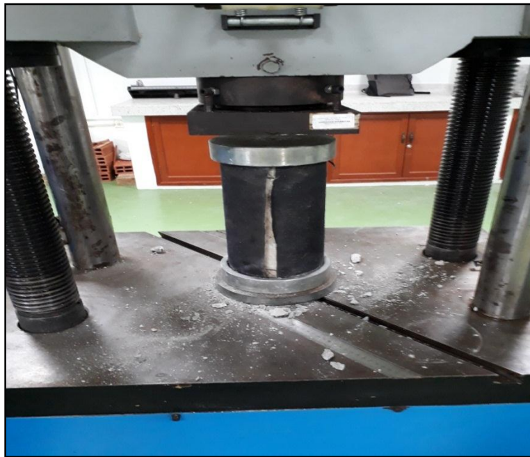
Figura 47. Falla de los cilindros ensayados a compresion sin fibra de polipropileno. Fuente: Autores del proyecto.
