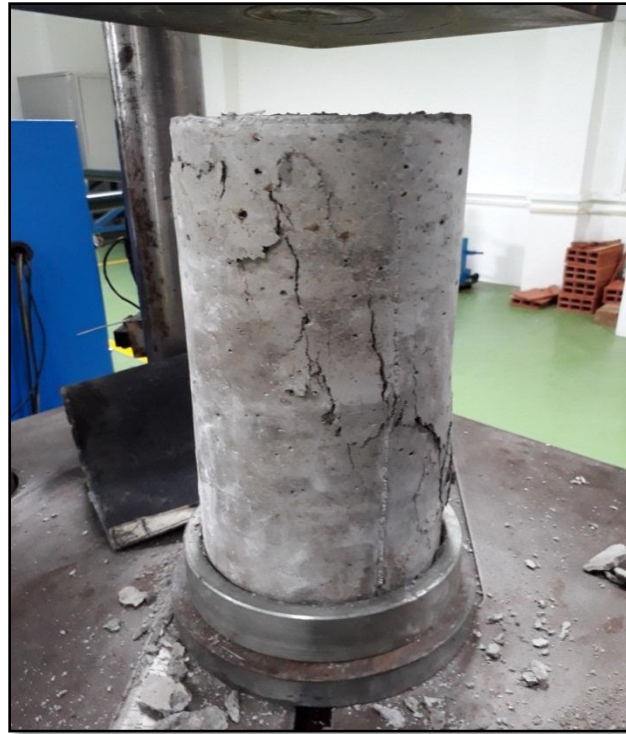
Figura 48. Falla de los cilindros ensayados a compresion con fibra de polipropileno. Fuente: Autores del proyecto.
