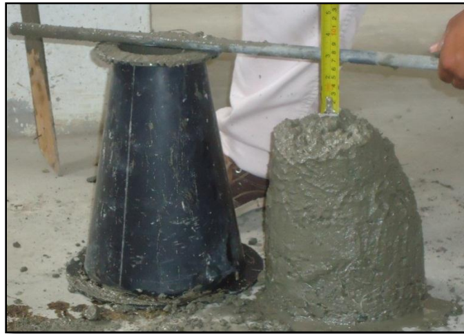
Figura 28. Procedimiento del cálculo de asentamiento (slump). Fuente: Autores del proyecto.
