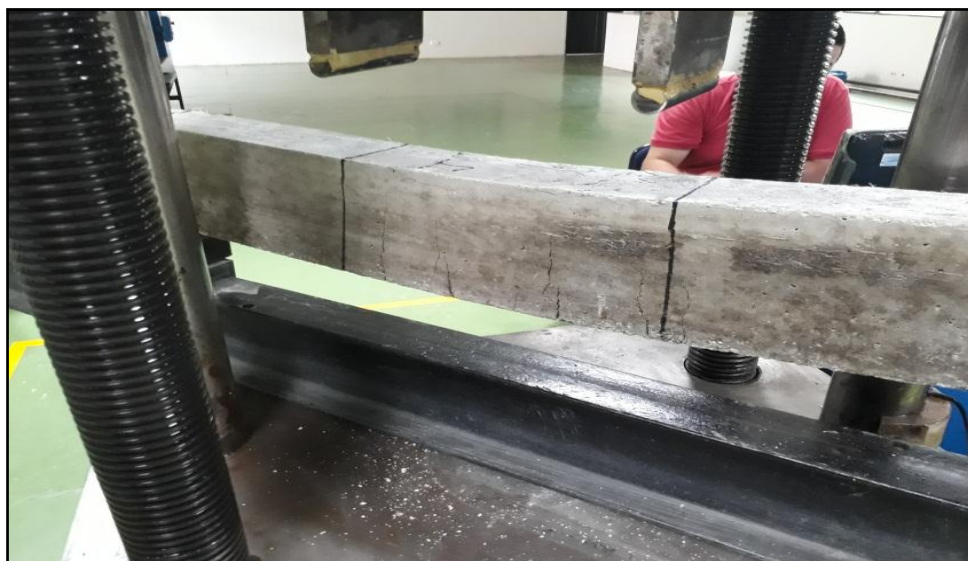
Figura 50. Falla característica de la viga reforzada con adición fibra de polipropileno. Fuente: Autores del proyecto.
