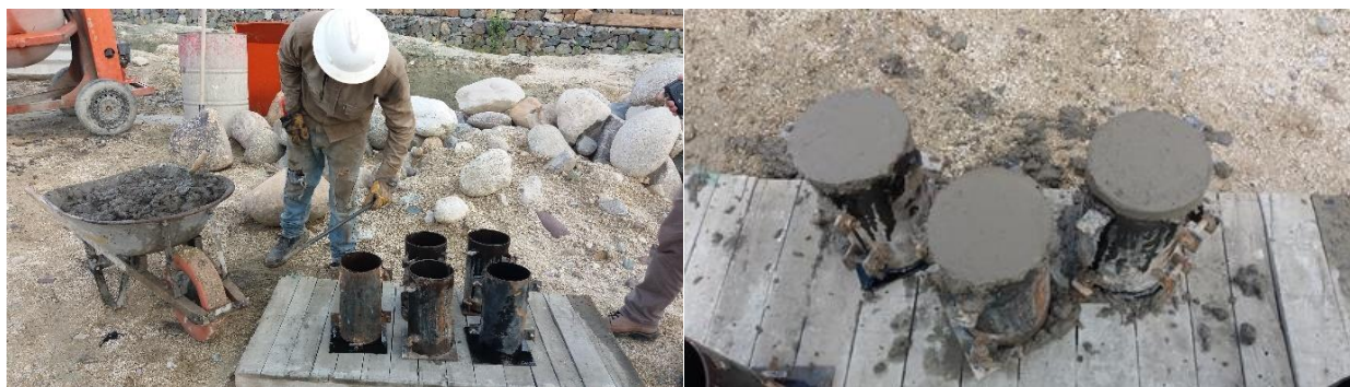
Figura 29. Toma y elaboración de muestras Fuente. Autor del proyecto
