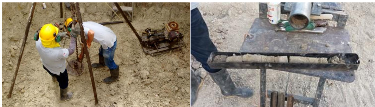
Figura 22. Toma de muestras para estudio de SPT Fuente. Autor 2018.
