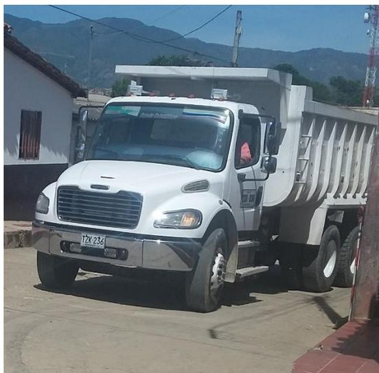
Fotografía 6. Volqueta para transporte de material.
