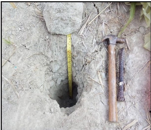
Excavación del cilindro para toma de datos.
