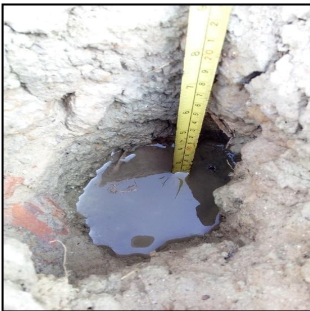
Vista del cilindro lleno de agua, para el análisis de infiltración.
