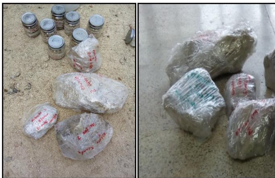
Figura 38. Muestras inalteradas para ensayos de peso unitario Fuente. Autores del proyecto
