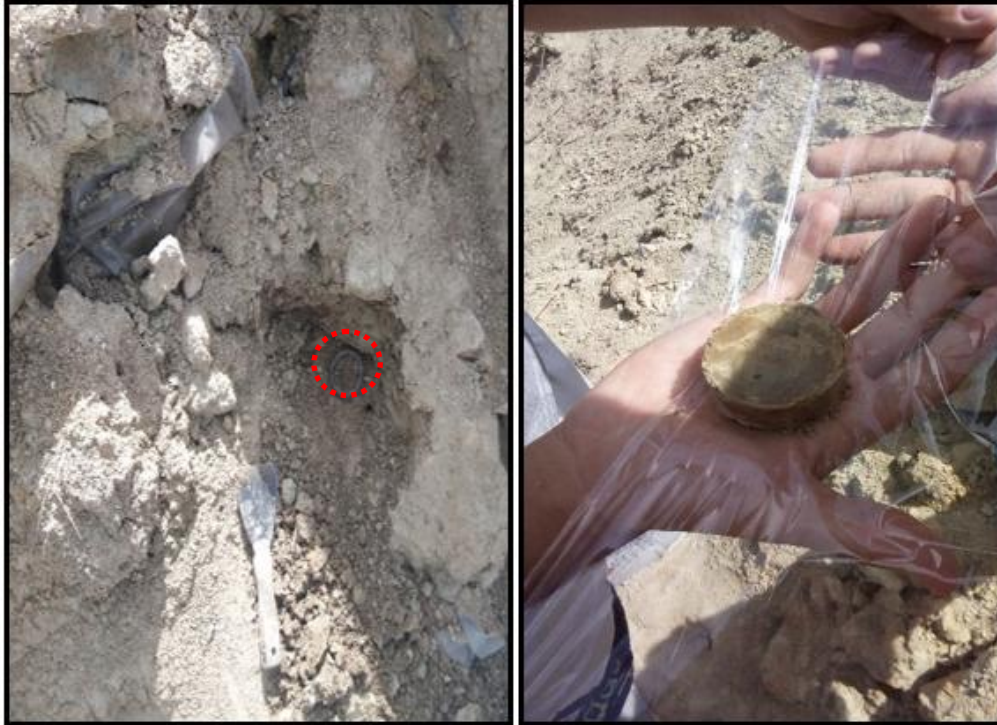
Figura 36. Anillo convencional de Corte, extracción de muestras in situ. Fuente. Autores del proyecto
