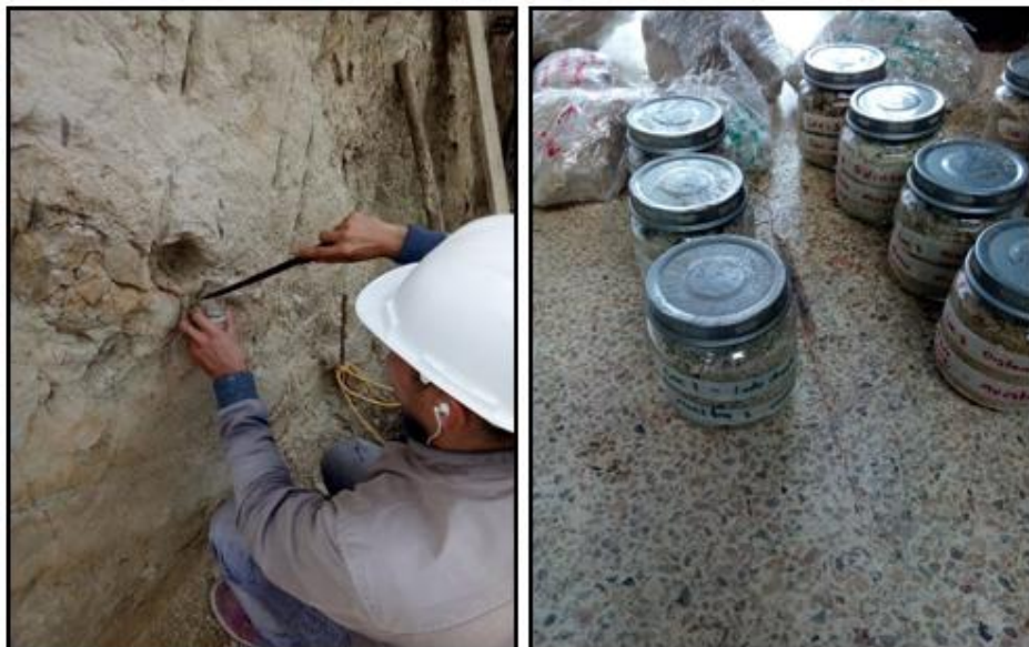
Figura 39. Muestra para ensayos de humedades naturales del suelo. Fuente. Autores del proyecto
